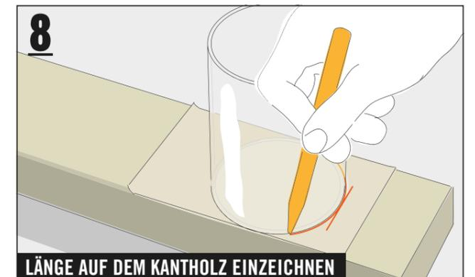
Wenn alle Bohrungen an den Tischbeinen hergestellt sind, wird die endgültige Länge auf dem Kantholz angezeichnet. Mit Hilfe eines runden Gefäß können die Rundungen angezeichnet werden.
