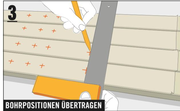
Von hier aus werden die vier Bohrpositionen mit dem Winkel auf das zweite Tischbein „2a“ und drei Bohrpositionen auf „2b“ übertragen. Beachte hierzu die Maßangaben in der Maßzeichnung zu „2a“ und „2b“. Für alle Bohrungen die Mitte der Hölzer anzeichnen. Dann passen die Tischbeine bei der Montage zusammen.
