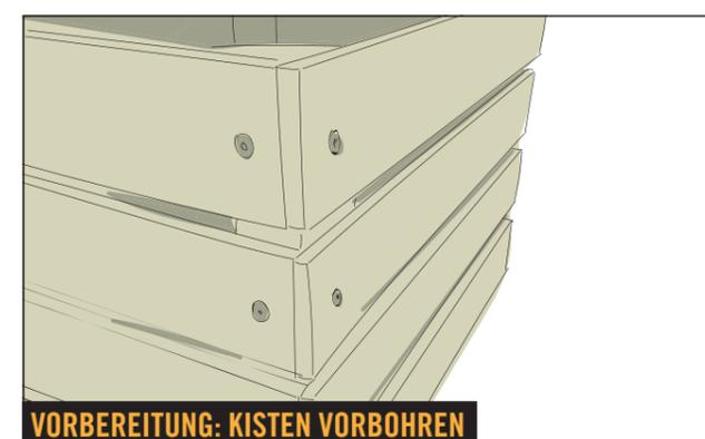
Zuerst die Kisten stabilisieren: Die Kisten vorbohren und anschließend jedes Leisten-Ende mit je einer Schraube (4,5x20 mm) am Dreikantholz fixieren (ca. 25 mm vom Rand der Kiste entfernt).
