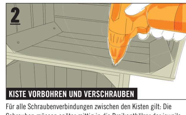
Für alle Schraubenverbindungen zwischen den Kisten gilt: Die Schrauben müssen später mittig in die Dreikanthölzer der jeweils benachbarten Kiste geschraubt werden können. Kisten 1 und 2: Die Schraubenlöcher in Kiste 2 mit dem „Bohrsenker“ vorbohren: je ein Loch vorne und hinten in das Dreikantholz unten links. Und rechts je ein Loch in die vordere und hintere Leiste mittig über dem Dreikantholz der unteren Kiste. Anschließend die beiden Kisten mit vier Schrauben 4,5x35 mm (T20) verschrauben.
