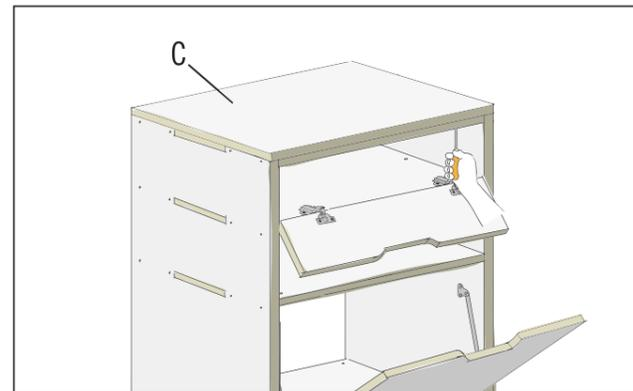
Senkkopfschrauben 3,5x35 mm. Lege die obere Schrankabdeckung (C) deckungsgleich auf die Deckplatte (A) auf. Sie wird von unten durch die Abdeckplatte mit Senkkopfschrauben 3x25 mm angeschraubt.
