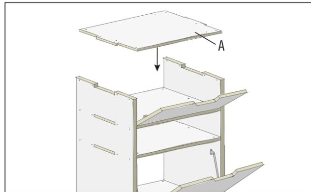
Jetzt die Deckplatte (A) - sie ist identisch mit der Bodenplatte (A) - auf die Wände aufstecken und durch die vorgesehenen Schraubenlöcher von oben verschrauben. Zusätzlich wird die Platte durch die beiden Seitenwände verschraubt. Die Verschraubungen erfolgen mit
