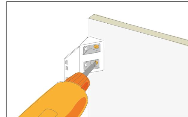
Damit die Frontplatte befestigt werden kann, muss auf jeder Seite ein Universal-Eckverbinder angeschraubt werden. Die Eckverbinder sitzen dabei vorne bündig an der Kante der Seitenwand. Schraube sie mit Senkkopfschrauben 3x16 mm an. Die Schraubenlöcher müs-
