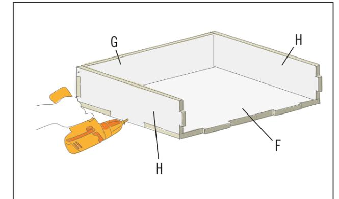
Verschraube die beiden Seitenwände (H) und die Rückwand (G) an der Grundplatte (F). Die Verschraubungen erfolgen von der Seite in die Grundplatte und dann durch die Grundplatte in die Wände. Es werden Senkkopfschrauben 3,5x35 mm verwendet.
