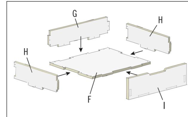
Die Einzelteile für die Montage der Schublade zurecht legen.
