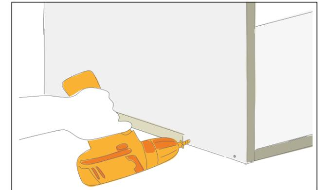
Verschraube die Seitenwand mit Senkkopfschrauben 3,5x35 mm durch die vorgebohrten Schraubenlöcher. Nach dem Eindrehen der seitlichen Schrauben werden von unten zwei weiteren Senkkopfschrauben 3,5x35 mm eingedreht.
