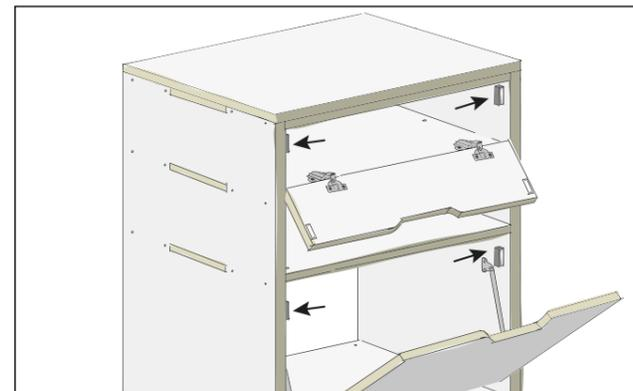
werden. Verwende jeweils Senkkopfschrauben 3x16 mm. Nach der Montage müssen die Türen vorne bündig am Korpus abschließen.
