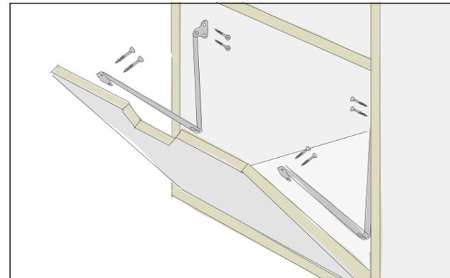
An die untere Schranktür kommen seitlich zwei Klappenhalter. Diese werden mit den mitgelieferten Schrauben befestigt.
