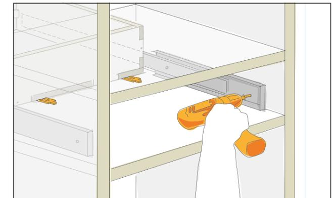
Setze die Schublade in die Schranköffnung ein und unterlege sie mit 2 mm dicken Keilen. Verschraube die Schubladenschienen am hinteren, dicken Teil an den Seitenwänden der Schranköffnung. Verwende Senkkopfschrauben 4x16 mm. Achte darauf, dass die Schienen parallel zur Schranköffnung montiert werden und sich die Schublade leichtgängig verschieben lässt.
