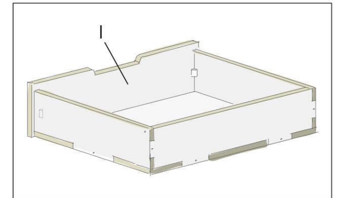
sen nicht vorgebohrt werden. Danach kann die Frontplatte (I) an den Zapfen der Seitenwände und Grundplatte aufgesteckt und an den Eckverbinder angeschraubt werden.
