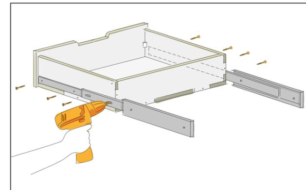
An der Schublade werden zwei Schubladenschienen angebracht. Ziehe die Schienen komplett auseinander und verschraube sie mit Senkkopfschrauben 4x16 mm durch den mittleren Teil des Auszuges direkt über der Bodenplatte der Schublade. Dann am vorderen Auszug ebenfalls an der Schublade verschrauben. Achte darauf, dass die Schienen parallel zur Schublade montiert werden.
