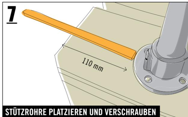
Die Stützrohre 110 mm vom Rand aus mittig auf der ersten Leiste der gekürzten Palette und 110 mm vom Rand auf der vorletzten Leiste der zweiten Palette platzieren. Danach die Fußplatte mit jeweils vier Schrauben (4,5x30 mm Pan-Head) und vier Unterlegscheiben (6,4 mm) fixieren.
