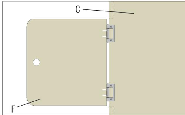
Die Klappe (F) wird mit zwei Lamellentürscharnieren am Bodenelement (C) befestigt.
