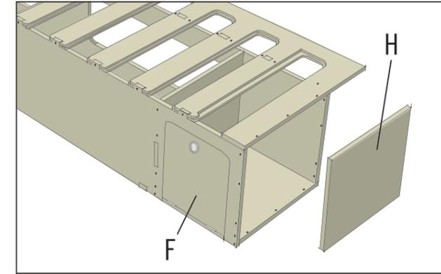
Setze die Abschlussplatte (H) an dem Ende der Konstruktion ein, wo sich auch die Klappe (F) befindet. Sie passt genau in den Freiraum und muss bündig vorne abschließen. Verschraube die Abschlussplatte (H) umlaufend mit der Konstruktion. Verwende dafür 3x25 mm Holzschrauben.
