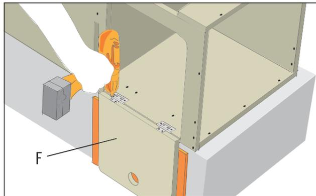
Um die Klappe (F) bequem an die Lamellentürscharniere schrauben zu können, kannst Du Dir eine Hilfskonstruktion aus Holz oder Karton bauen. So wird der Korpus hochgebockt und die Klappe (F) an ihrer Schmalseite mit den Scharnieren verschraubt. Verwende hierfür wieder Senkkopf Holzschrauben 3x16 mm. Um den richtigen Abstand
