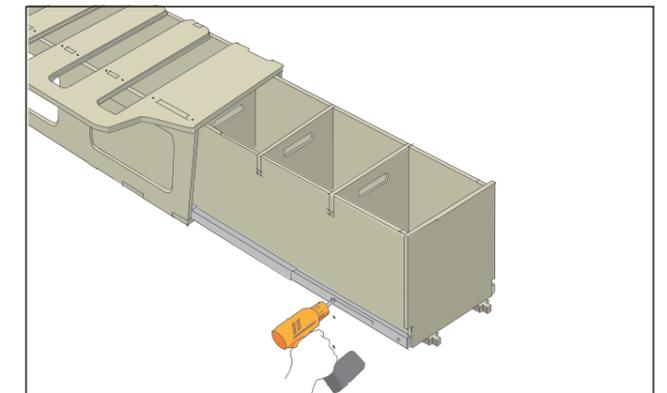
Stelle die Schublade zwischen die beiden Schienen auf die Unterlegkeile und verschraube sie mit Holzschrauben 4,5x16 mm.
