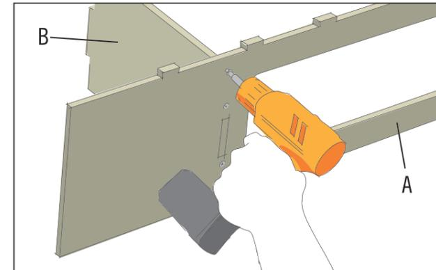
Kippe die Konstruktion nach vorne und verschraube das Seitenteil (A) von hinten mit der Zwischenwand (B) durch die dafür vorgesehenen Bohrlöcher. Dafür benötigst Du vier Holzschrauben 3x25 mm.
