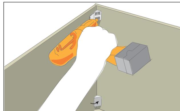
In allen vier Innenecken werden je zwei Eckverbinder verschraubt, um der Schublade noch mehr Stabilität zu verleihen. Benutze dafür Holzschrauben 3x16 mm. Die Eckverbinder haben Klappen, die nach dem Verschrauben durch Andrücken geschlossen werden.
