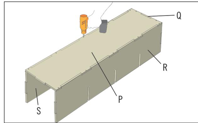
Füge analog dazu auch die Seitenwand (S) an und drehe die Konstruktion dann um 180°, sodass die Bodenplatte (P) nach oben zeigt, um die Abschlussplatte (Q) und die Seitenwände (R) und (S) mit der Bodenplatte (P) durch die vorgesehenen Bohrlöcher zu verschrauben. Nimm hierfür Holzschrauben 3x25 mm.
