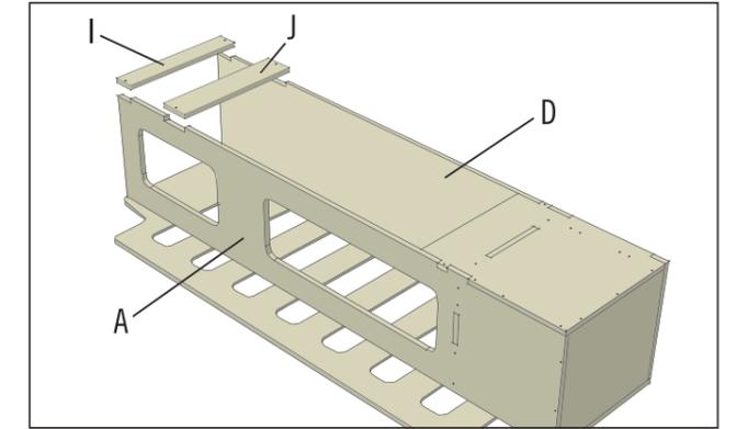
Drehe die Konstruktion nun um 180°, sodass das Rostelement (E) nach unten zeigt. Füge am Ende die beiden Stützbretter (I) und (J) ein und verschraube sie mit Holzschrauben 3x25 mm. Die Bretter verbinden die Seitenteile (A) und (D) und stabilisieren das Stauraum-Bett. Beachte, dass das etwas schmalere Stützbrett (I) am Ende sitzt.
