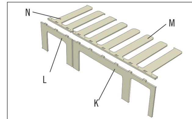
Das ausziehbares Rostelement besteht aus vier Einzelteilen. Stecke (N) auf (L) und (M) auf (K). Die Verzapfungen passen genau ineinander. Anschließend verschraubst Du die Elemente von oben durch die vorgesehenen Bohrlöcher mit Holzschrauben 3x25 mm.
