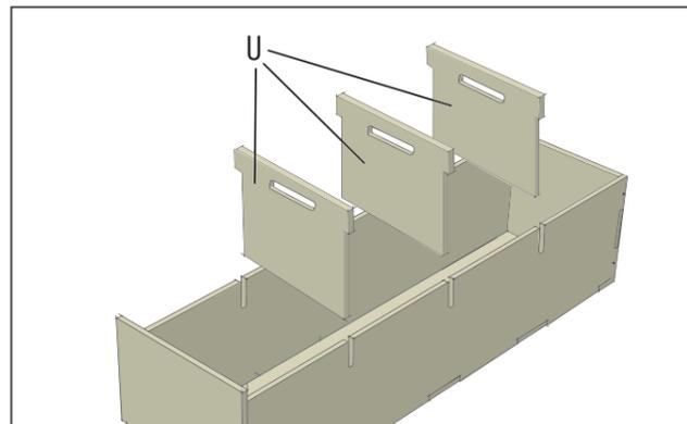
Die drei Trennwände (U) werden von oben an den vorgesehenen Stellen eingeschoben. So erhältst Du vier getrennte Fächer in der Schublade.
