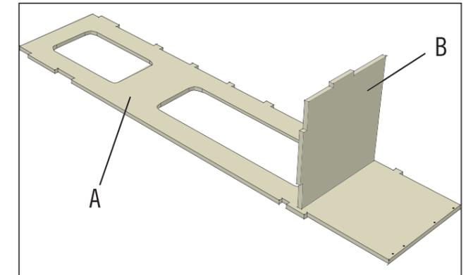
Stecke die Zwischenwand (B) auf das Seitenteil (A). In der Zwischenwand ist dafür ein Zapfen vorgesehen, der genau in die dafür vorgesehene Ausfräsung im Grundelement passt. Die Seite mit dem längeren Zapfen zeigt dabei nach vorne.
