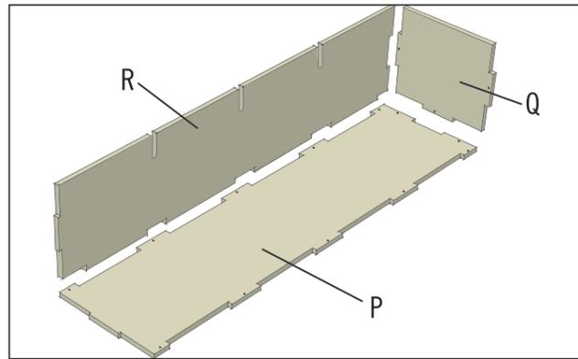
Montiere nun noch die Schublade. Dafür legst Du die Bodenplatte (P) auf Deine glatte, saubere Unterlage, fügst zunächst die Abschlussplatte (Q) und dann die Seitenwand (R) an. Die Verzapfungen greifen wieder genau ineinander.
