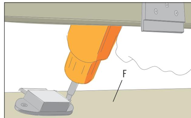
An der oberen Kante der Klappe (F) ist eine runde Ausfräsung für das Möbelschloss vorgesehen. Dieses wird mit Holzschrauben Senkkopf 3x16 mm an der Klappe (F) verschraubt. Von außen lässt sich das Schloss per Knopfdruck bedienen.
