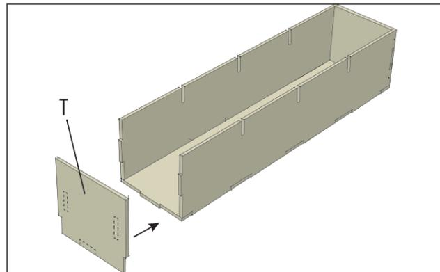
Vervollständige den Schubladenkorpus noch durch Aufstecken der Frontplatte (T). Mit einem Gummihammer kannst du vorsichtig nacharbeiten, bis die Frontplatte gut sitzt.
