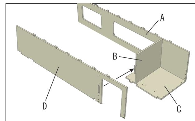
Kippe die Konstruktion wieder nach vorne und füge das Seitenteil (D) parallel zum Seitenteil (A) an. Die Zapfen in (B) und (C) greifen genau in die Ausfräsungen des Seitenteils (D), in dem sich Bohrlöcher befinden, durch die es mit der Konstruktion verschraubt wird. Verwende wieder Holzschrauben 3x25 mm.
