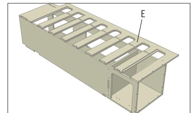
Von oben wird das Rostelement (E) aufgesteckt und durch die vorgesehenen Bohrlöcher mit 3x25 mm Holzschrauben verschraubt.
