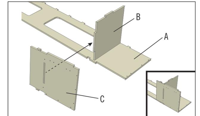
(A) und (B) aufgesteckt, sodass der längere Zapfen der Zwischenwand (B) in die dafür vorgesehene Ausfräsung in (C) greift. Verschraube das Bodenelement (C) durch die beiden Bohrlöcher neben der Verzapfung mit (B). Nimm dafür Holzschrauben 3x25 mm. Mit derselben Schraubensorte verbindest Du auch (C) mit (A) durch die vier dafür vorgesehenen Bohrlöcher.
