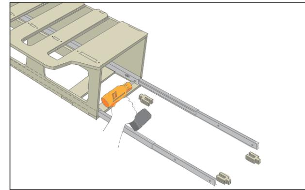
Damit die Schublade nachher leicht gleiten kann, schraubst du rechts und links auf gleicher Höhe zwei Schubladenschienen in den Korpus des Stauraum-Bettes. Schraube die Schienen ganz unten mit Holzschrauben 4,5x16 mm fest. Achte darauf, dass sie absolut gerade sitzen.
