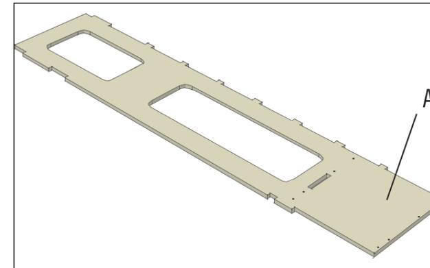
Lege das Seitenteil (A) auf einen glatten, sauberen Untergrund. Zum Schutz des Werkstückes und des Bodens kannst Du einen Kartonbogen in passender Größe unterlegen. Das Seitenelement weist zwei Durchlässe auf. Platziere es so, dass der schmalere Durchlass links liegt und die Seite mit den acht Zapfen nach hinten zeigt.
