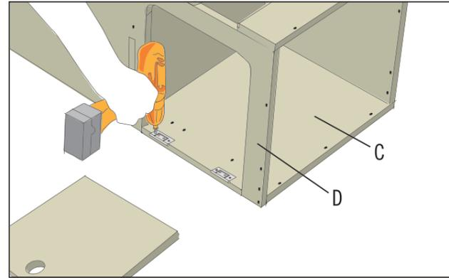
Schraube die Lamellentürscharnieren zunächst an die Kante des Bodenelementes (C), unten innerhalb der Klappenöffnung des Seitenteils (D). Die Scharnierachsen funktionieren dabei als Anschlag. Rücke die Scharniere so weit an das Bodenelement (C), sodass die Achsen bündig anstoßen und verschraube jeweils das äußere Scharnierteil mit dem Korpus. Verwende hierfür Senkkopf Holzschrauben 3x16 mm.
