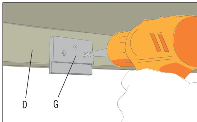
Der Anschlag (G) für das Möbelschloss der Klappe wird im Stauraum von innen oben in der Mitte der Klappenöffnung an das Seitenteil (D) geschraubt. Du brauchst dafür drei Holzschrauben Senkkopf 3x16 mm.
