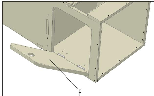
einzuhalten, kannst Du ein Brettchen in der Stärke der Scharnierachsen dazwischen klemmen. Prüfe, ob sich die Klappe (F) öffnen und schließen lässt, ohne zu haken. Gegebenenfalls musst Du die Verschraubung der Scharniere noch etwas nachbessern.
