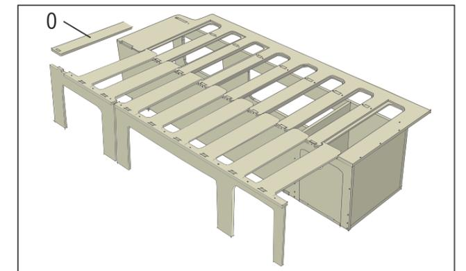
In ausgefahrenem Zustand des Rostes wird das Arretierstück (O) eingesetzt, um die Konstruktion zu stabilisieren. Dieses kann optional zur Aufbewahrung mit Klettband am Korpus befestigt werden, um es bei Bedarf gleich zur Hand zu haben.
