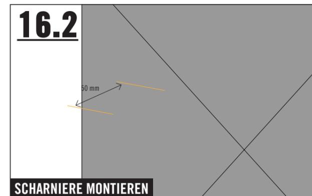
Die beiden Scharniere (64x34 mm) mit je drei Schrauben (3,5x16 mm) auf der langen Seite (600 mm) mit je einem Abstand von 50 mm zur Außenkante auf dem Stützbrett montieren.
