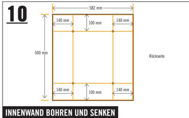
Die Innenwand entsprechend der Skizze mit dem Vorbohrer mit Senker bohren und senken. Durch diese Bohrlöcher verschraubst Du die Innenwand später mit der Front.
