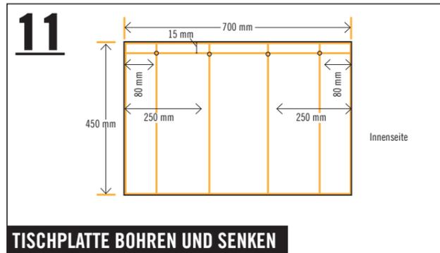
Die Tischplatte entsprechend der Skizze mit dem Vorbohrer mit Senker bohren und senken. Durch diese Bohrlöcher verschraubst Du die Innenwand später mit dem Stützbrett. Achtung: Beim Bohreraustritt auf der Sichtseite kann es zum Abplatzen der Melaminharzbeschichtung kommen. Eventuell mit 2mm-Bohrer vorbohren.
