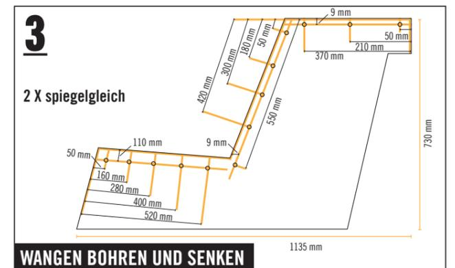
Die Wangen entsprechend der Skizze mit dem Vorböhrer mit Senker bohren und senken. Die Wangen übereinanderlegen und in einem Arbeitsgang bohren – das erspart ein zweites Anzeichnen. Die Bohrungen der unten liegenden Wange anschließend von der anderen Seite senken, sodass die Wangen spiegelgleich werden (rechts + links). Durch diese Bohrflöcher verschraubst Du später beide Wangen mit der Sitzfläche, der Rückenlehne und der Tischplatte. Weitere Bohrskizze siehe Schritt 4.
