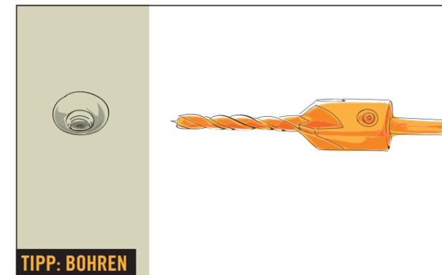
Für das Bohren empfiehlt sich ein „Vorböhrer mit Senker“. Damit entsteht am oberen Ende des Bohrlochs ein Konus, der Platz für den Schraubenkopf bietet. Der Schraubenkopf steht dadurch nicht über, und Du vermeidest Risse im Holz!
