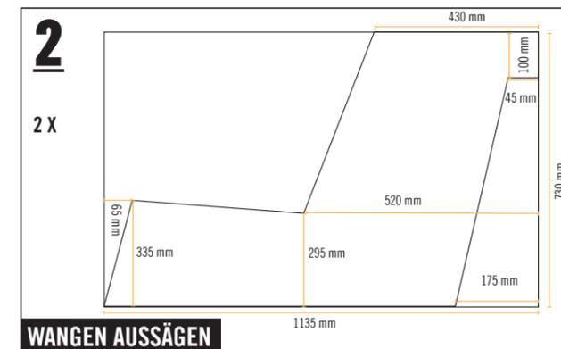
Die beiden Wangen aus den Sperrholzplatten (730x1135 mm) entsprechend der Skizze aussägen – vor dem ersten Schnitt alle Messpunkte und Schneidlinien einzeichnen. Danach die frischen Sägekanten schleifen, bis alle rauen Stellen glatt sind.
