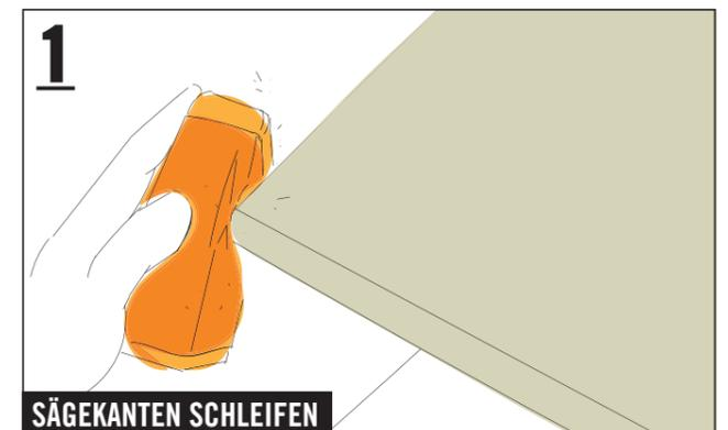
Schleifpapier um den Handschleifklotz wickeln und die Sägekanten schleifen, bis alle rauen Stellen glatt sind.
