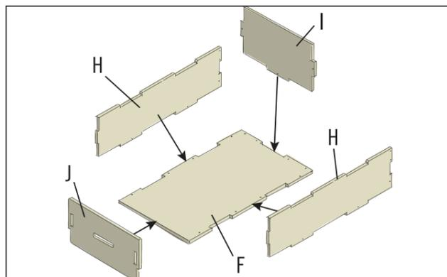
Montiere beide Schubladen. Die Seitenwände (H) und die Rückwand (I) werden an den Aussparungen der Grundplatte (F) eingesetzt. Die Verschraubung erfolgt von unten durch die Grundplatte mit 3,5x35 mm Schrauben. Zusätzlich werden diese seitlich am unteren Rand an den vorhandenen Schraubenlöchern verschraubt. Die Frontseite (J) wird an den Seitenwänden aufgesteckt.
