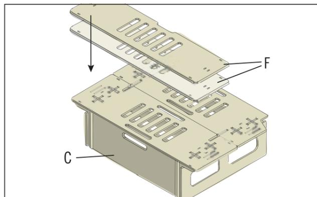
Zum Montieren der beiden weiteren Abdeckplatten (F) die Frontplatte (C) nach vorne herausziehen.
