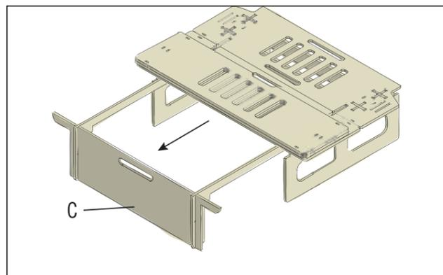
Lege die Abdeckplatten mit der Rückseite nach oben auf das herausgezogene Bauteil.
