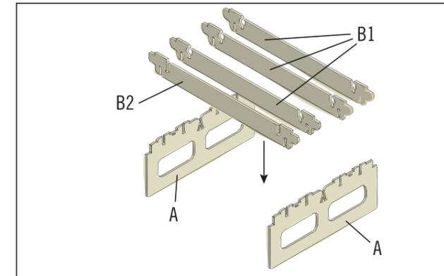
Stelle die beiden Seitenwände (A) mit einem Helfer auf. Die drei Streben (B1) und die Strebe (B2) dann von oben in die Aussparungen der Seitenwände einstecken.
