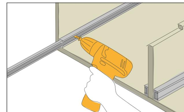
Verschraube die Schubladenschienen so, dass diese im eingeschobenen Zustand vorne bündig sind. Es werden 4x16 mm Schrauben benötigt. Die Schraubenlöcher müssen nicht vorgebohrt werden.
