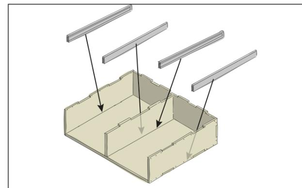
In beide Schubladenfächer kommen jeweils zwei Schubladenschienen. Die Schienen haben eine Breite von 19 mm. Bringe diese am besten unten am Boden des Korpus an. Hier sind diese am leichtesten zu montieren.
