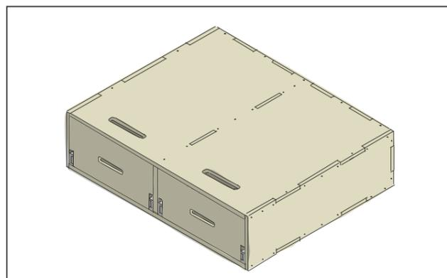
Das Modul muss nun im Auto noch verankert/gesichert werden. Es kann auch in das hierzu passende Bett „Marinus“ eingebaut werden. Es werden hierzu zwei weitere Schubladenschienen benötigt. Falls die verwendeten Schienen keine Auszugsicherung haben, denke daran die Schubladen vor Herausgleiten zu sichern.
