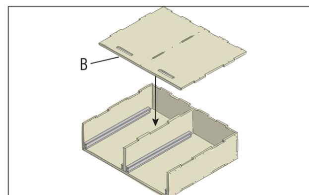
Nach dem Einbau der Schubladenschienen kann die Gehäuseabdeckung (B) aufgelegt und mit 3,5x35 mm Schrauben an der Zwischenwand, den Seitenwänden und der Rückwand verschraubt werden.
