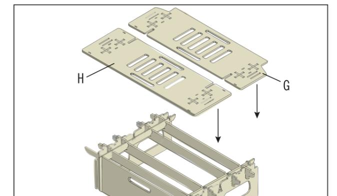
Schiebe die Frontplatte wieder zurück. Jetzt die Abdeckplatte (G) am hinteren Ende so auf die unteren Bauteile aufstecken, dass die ausgesparten Ecken nach außen angeordnet sind. Die Abdeckplatte (H) bündig daran ansetzen und ebenfalls aufstecken.
