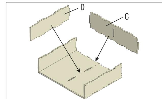
Die Rückwand (C) und die Zwischenwand (D) ebenfalls in die Aussparungen einsetzen und von der Unterseite der Grundplatte verschrauben. Die Seitenwände werden dann noch mit der Rückwand an den vorgesehenen Bohrlöchern verschraubt. Die Zwischenwand wird mit der Grundplatte und der Rückwand verschraubt.
