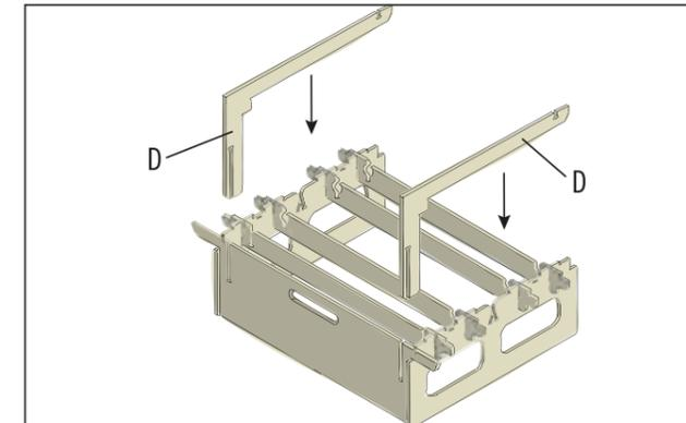
Die beiden Winkelstreben (D) in die Aussparungen der Frontplatte einstecken. Die langen Enden der Winkelstreben werden dabei in die oberen Aussparungen an den Streben (B1 und B2) eingesetzt.
