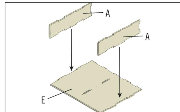
Zur Verschraubung der gesamten Holzkonstruktion des Schubladengehäuses werden 3,5x35 mm Schrauben verwendet. Die beiden Seitenwände (A) an den Aussparungen der Grundplatte (E) einsetzen. Das Bauteil aufstellen und die Seitenwände von unten durch die Grundplatte an den vorhandenen Bohrlöchern verschrauben. Zusätzlich werden die Seitenwände von außen an der Grundplatte angeschraubt.
