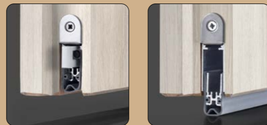
Bodendichtung eingeklappt Bandseite und abgesenkt Schlossseite Jedes Schallschutzelement besitzt eine absenkende Bodendichtung im Türblatt. Beim Schließen der Tür wird die Dichtung automatisch abgesenkt.
