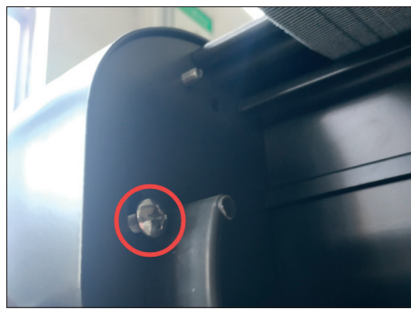
5. Avec un tournevis, dévisser les vis du cache décoratif.
