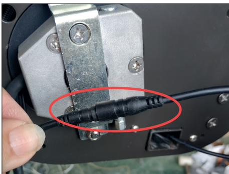
10. Débrancher le connecteur LED.
