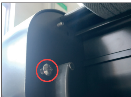
5. Utilizați o șurubelniță pentru a slăbi șuruburile cu capac decorativ.
