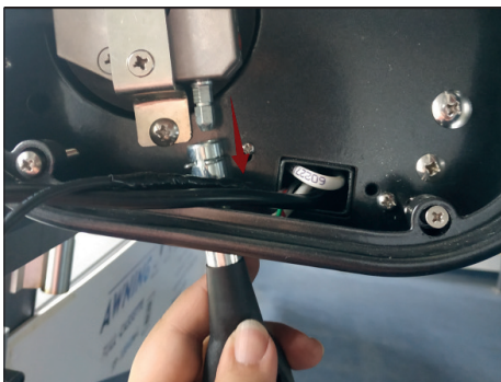
7. Ziehen Sie den Sicherungsring von der Kurbelöse und entnehmen Sie diese.
