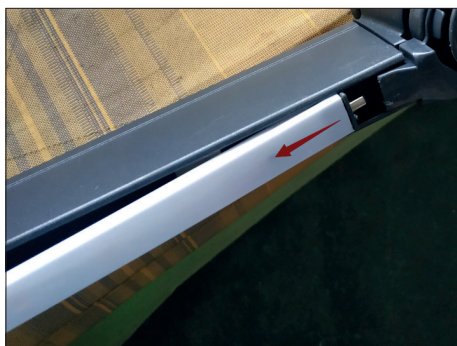
7. Lossa LED-rören från de små bjälkarna.
