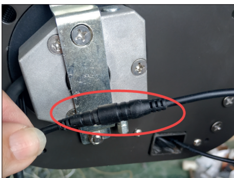
10. Koppla loss LED-kontakten.
