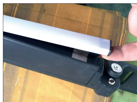
6. Trek de LED-lichtbuizen van de korte balken er aan de voorzijde van de balk uit.
