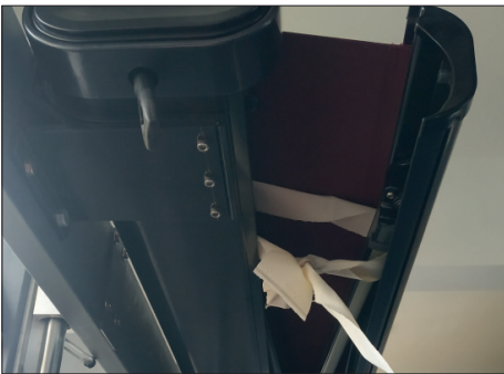
4. Zet de veerbelaste armen stevig met riemen vast om te voorkomen dat ze openspringen.
