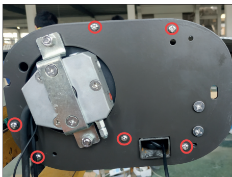
11. Skruva bort skruvarna som fäster den inre kåpan.
