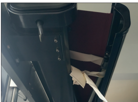
4. Pružinové ramená pevne priviažte popruhmi, aby sa náhle neotvorili.
