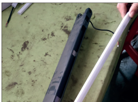
4. Dra försiktigt ut LED-rören från de långa bjälkarna.
