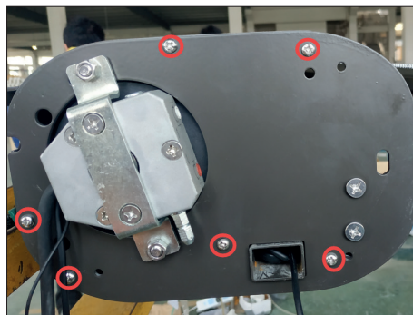
11. Dévisser les vis fixant le cache intérieur.
