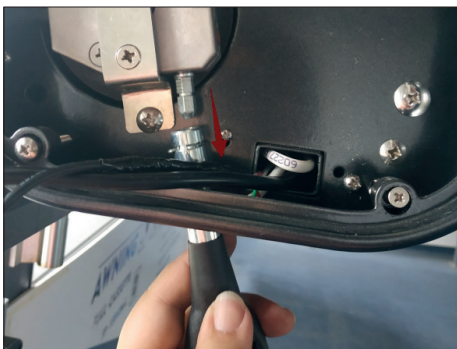
7. Retirer la fixation de l'œilleton de manivelle et tirez-le.
