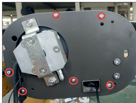
11. Draai de schroeven eruit waarmee de binnenkap is bevestigd.
