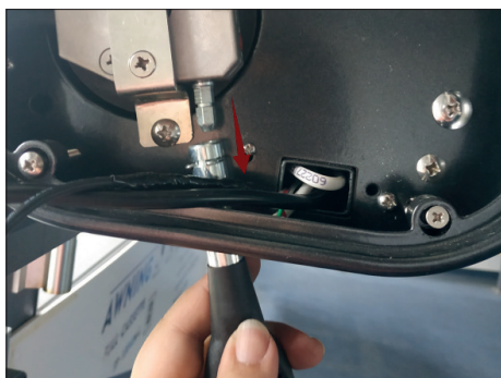
7. Sejměte pojistný rozpěrný kroužek z očka kliky a vytáhněte očko kliky.
