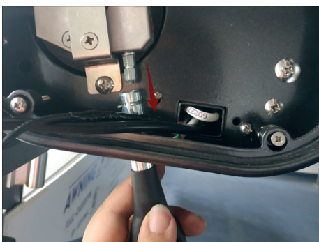
7. Z kľúky s okom odstráňte poistný krúžok a vytiahnite ju.
