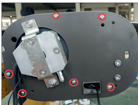
11. Vyšroubujte šrouby upevňující vnitřní kryt.
