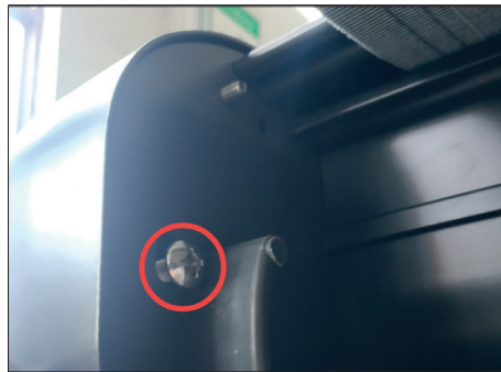
5. Lösen Sie die Zierkappe mit einem Kreuzschlitzschraubenzieher.
