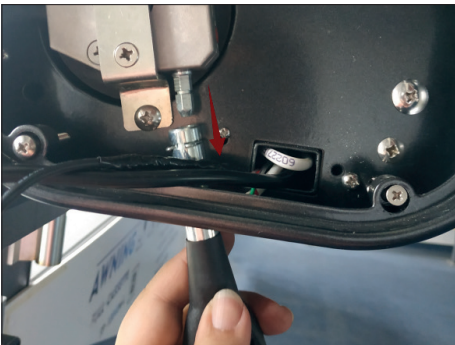
7. Verwijder de borgring van het slingeroog en trek het slingeroog eruit.
