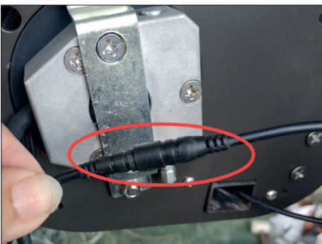
10. Koppel de LED-connector los.
