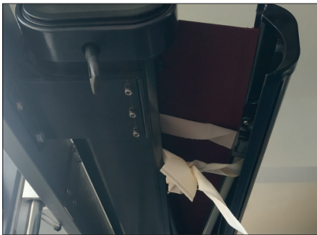
4. Sichern Sie die Gelenkarme mit Bändern, so dass sie in Schritt 6 nicht durch den Federdruck aufschnellen können.
