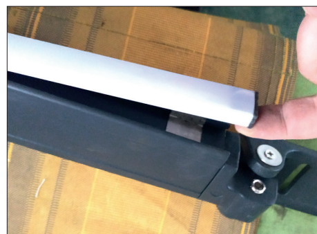
6. Dra ut LED-rören från de små bjälkarna på frambjälkens sida.
