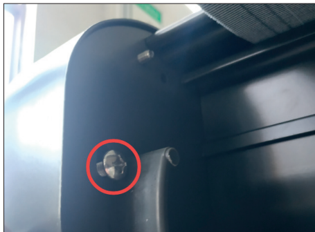
5. Använd en skruvmejsel för att lossa det dekorativa skyddets skruvar.
