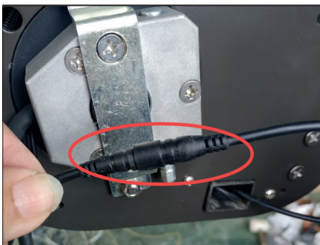
10. Trennen Sie die Steckverbindung der LED-Beleuchtung.
