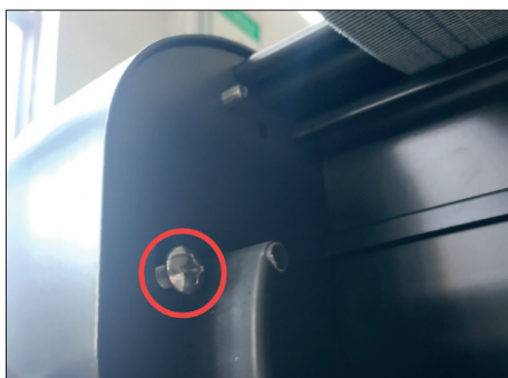
5. Skrutkovačom odskrutkujte skrutky upevňujúce dekoratívny kryt.
