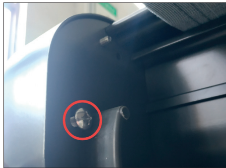
5. Gebruik een schroevendraaier om de schroeven van de decoratieve afdekking los te draaien.
