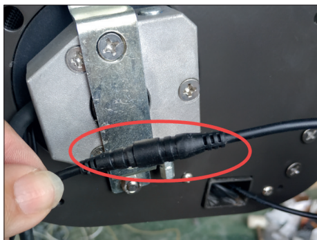
10. Deconectați conectorul LED.
