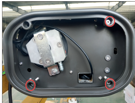
8. Schroef de schroeven van de eindkap eruit.
