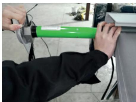
**7.** Tirer le moteur et la plaque de fixation du boîtier hors du tube d'enroulement.
