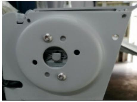
**4.** Na odstránenie skrutiek zaistenovacej dosky krytu použite skrutkovac.
