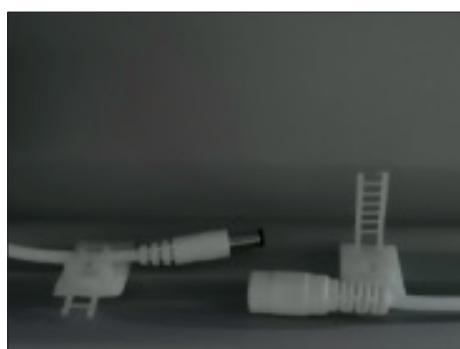
**7.** Öffnen Sie die Kabelhalter und trennen Sie die Steckverbinder.
