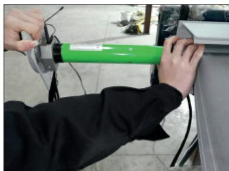
**7.** Ziehen Sie Motor und Verschlussplatte aus der Markisenachse.
