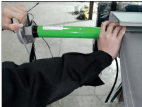
**7.** Scoateți motorul și placă de blocare a carcasei din tubul ruloului.
