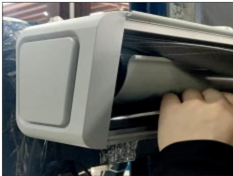
**2.** Gebruik een 4# inbussleutel om de schroeven van de zijkap van de kap te verwijderen.
