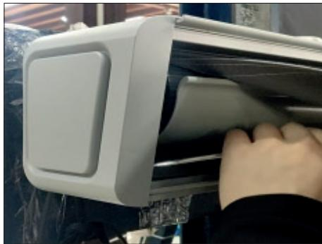
**2.** Na odstránenie skrutiek bočného uzáveru krytu použite imbusový kľúč č. 4.
