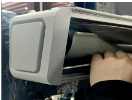
**2.** Folosiți o cheie hexagonală #4 pentru a scoate șuruburile de la capacul lateral al carcasei.
