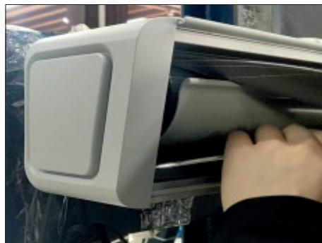
**2.** Utiliser une clé Allen n° 4 pour retirer les vis du cache latéral du boîtier.
