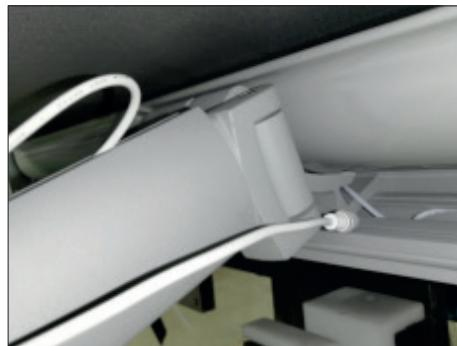
**3.** Koppla bort kontakerna på LED-remsorna från axelfästet.
