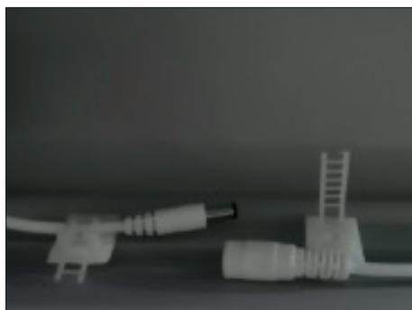
**7.** Desfaceți suporturile de cabluri și decuplați mufele de cabluri.
