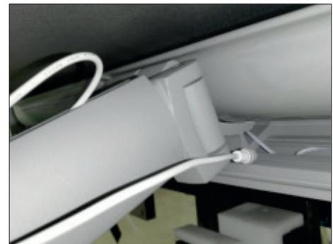
**3.** Débrancher les connecteurs des bandes LED de la fixation d'épaule.
