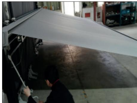
**1.** Trennen Sie die Markise vom Netz und öffnen Sie diese mit der Handkurbel.
