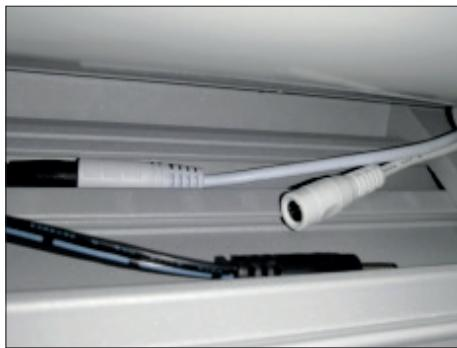
**2.** Odpojte konektory vodičů uvnitř krytu a LED pásků v ramenech.
