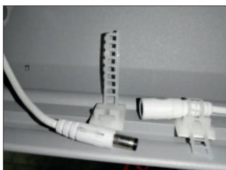
**4.** Desfaceți suporturile de cabluri de la benzile cu LED-uri de pe brațe, apoi decuplați mufele de cabluri ale benzilor cu LED-uri și cablul de pe bara frontală.
