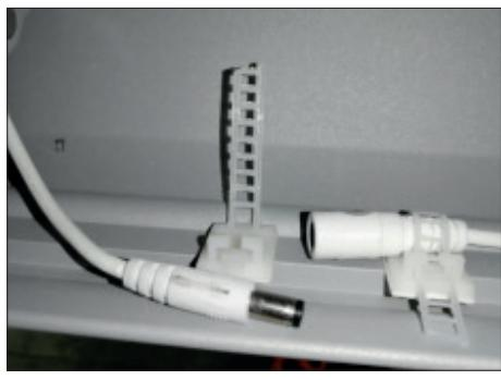
**4.** Otevřete držáky vodičů LED pásků v ramenech, potom odpojte konektory LED pásků a konektor v přední tyči.
