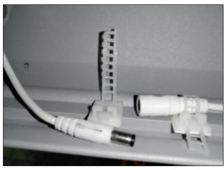
**4.** Open de draadhouders van de LED-strips in de armen en koppel vervolgens de connectoren van de LED-strips en die in de frontbalk los.
