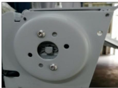
**4.** Utiliser un tournevis pour retirer les vis de la plaque de fixation du boîtier.
