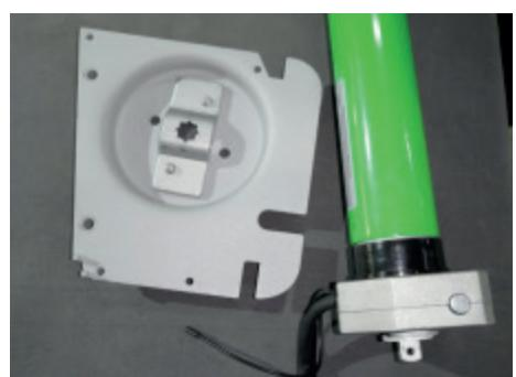
**9.** Separare la piastra di bloccaggio e il motore.
