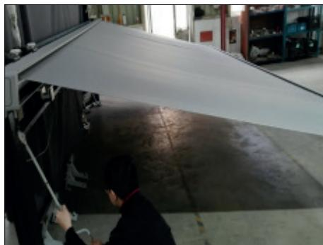
**1.** Decuplați alimentarea cu energie și folosiți manivela pentru a deschide marchiza, sau decuplați alimentarea cu energie după ce ați deschis marchiza prin acționare electrică.
