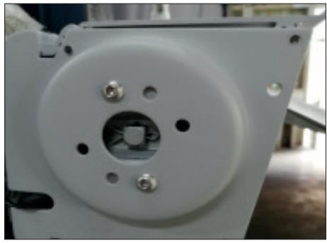
**4.** Gebruik een schroevendraaier om de schroeven van de vergrendelingsplaat van de kap los te draaien.
