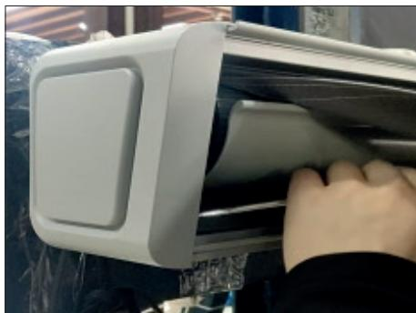
**2.** Använd en 4# insexnyckel för att skruva bort skruvarna på huvens sidokåpa.
