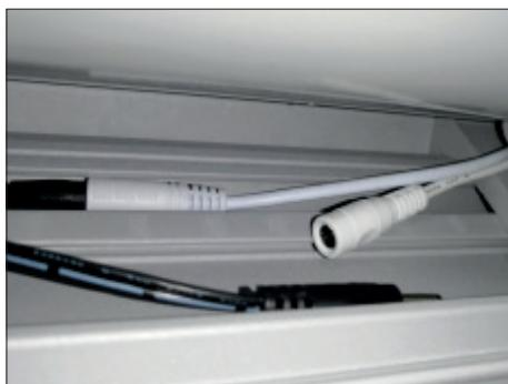
**2.** Odpojte konektory vodičov vo vnútri krytu a LED svetelné pásy v ramenach.
