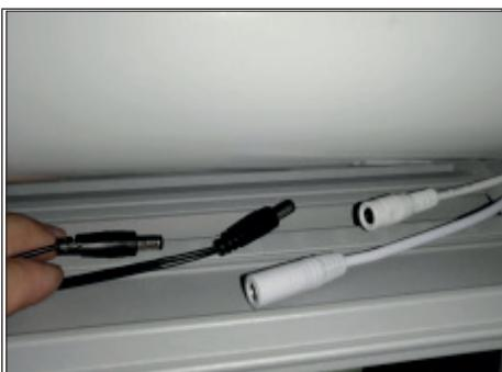
**5.** Separera kontakten på LED-remsan och den på motorn.
