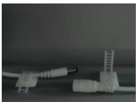
**7.** Otvorte držiaky vodičov a odpojte konektory vodičov.
