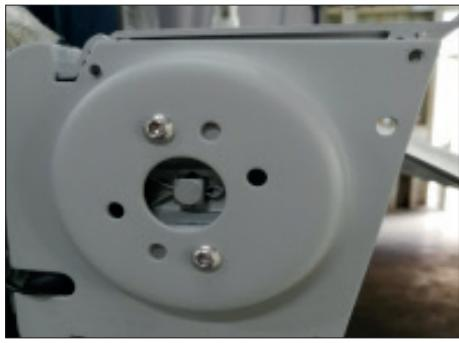
**4.** Folosiți o șurubelnită pentru a scoate șuruburile din placa de blocare a carcasei.
