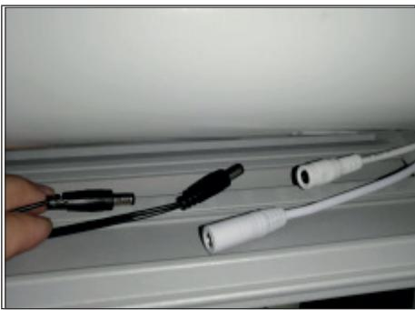
**5.** Oddelte konektor LED svetelného pásu a konektor motora.
