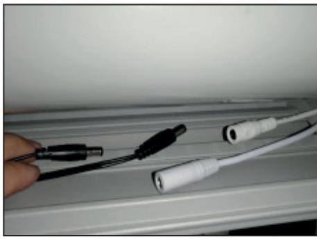
**5.** Lösen Sie die Steckverbinder der LED-Streifen von denen des Motors.
