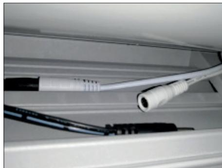
**2.** Débrancher les connecteurs de câbles de l'intérieur du boîtier et les bandes LED des bras.
