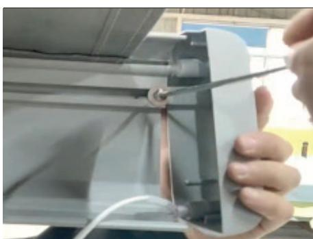
**8.** Entfernen Sie die seitlichen Abdeckungen des Ausfallprofils.
