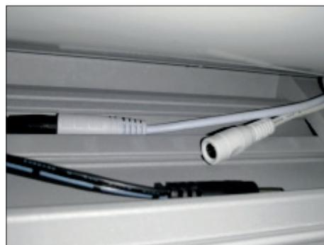
**2.** Decuplați mufele cablurilor din interiorul carcasei și ale benzilor cu LED-uri din brațe.
