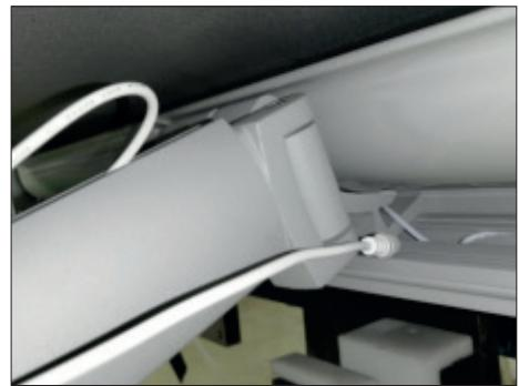
**3.** Odpojte konektory LED pásků od držáku ramena.
