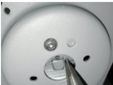
**8.** Entnehmen Sie den Splint mit einer Pinzette. Den Splint aufbewahren.
