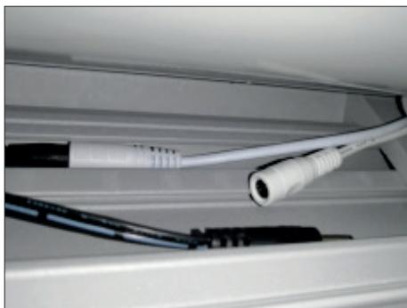
**2.** Trennen Sie die Steckverbinder in der Kassette von den LED Streifen im Gelenkarm.
