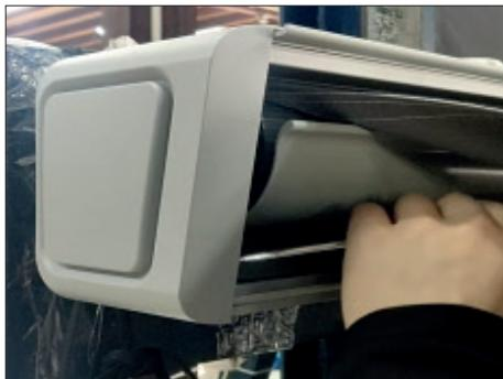
**2.** Lösen Sie mit einem 4er Innensechskantschlüssel die linke Kassettenabdeckung.
