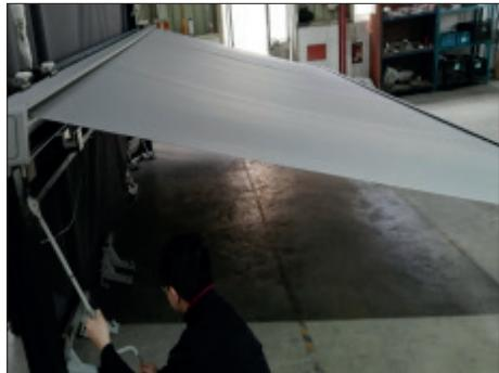
**1.** Vypněte zdroj energie a použijte ruční kliku na otevření markýzy.
