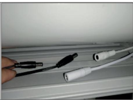
**5.** Scheid de connector van de LED-strip en die van de motor.
