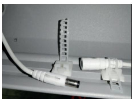
**4.** Otvorte držiaky vodičov LED svetelných pásov v ramenach, potom odpojte konektory LED svetelných pásov a konektor v prednej lište.
