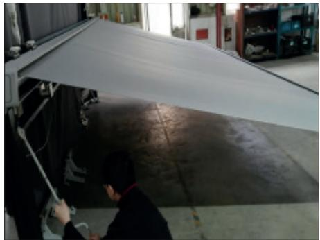
**1.** Stäng av strömmen och använd handveven för att öppna markisen, eller stäng av strömmen efter att du har öppnat markisen elektriskt.
