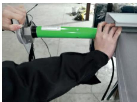
**7.** Estrarre il motore e la piastra di bloccaggio del cappuccio dal rullo avvolgitore.
