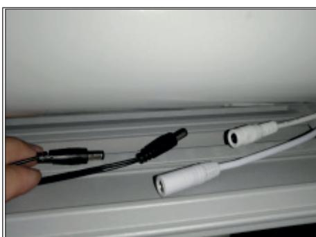
**5.** Séparer le connecteur de la bande LED et celui du moteur.
