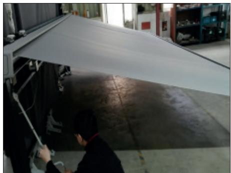
**1.** Vypnite napájanie a markízu otvorte pomocou ručnej kľúču alebo vypnite napájanie po elektrickom otvorení markízy.
