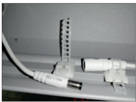
**4.** Öppna ledningshållarna för LED-remsorna i armarna. Koppa sedan bort kontakerna på LED-remsorna och i den främre skenan.
