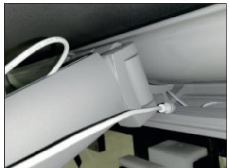
**3.** Trennen Sie die Steckverbinder der LED Streifen am Schultergelenk.
