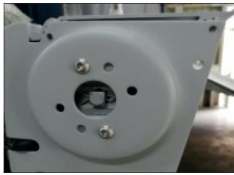
**4.** Lösen Sie die Verschlussplatte mit einem Kreuzschlitzschraubendreher.
