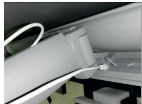
**3.** Decuplați cablurile benzilor cu LED-uri din consola cu cot.
