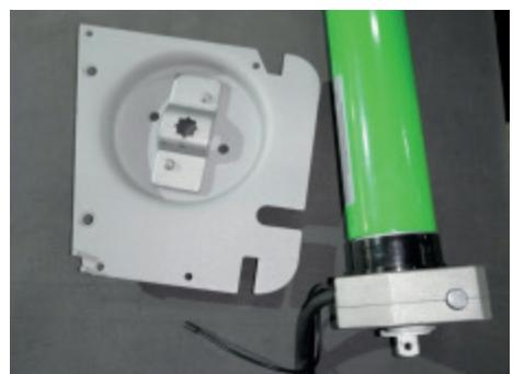
**7.** Vytáhněte motor a zamýkací destičku krytu z navíjecího válce.
