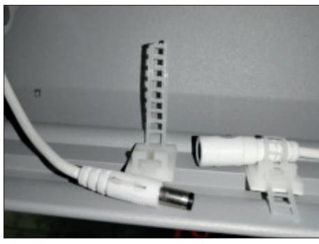
**4.** Ouvrir les fixations de câbles des bandes LED des bras, puis débrancher les connecteurs des bandes LED et celui de la barre avant.
