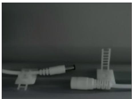
**7.** Öppna ledningshållarna och koppla ur ledningskontakerna.
