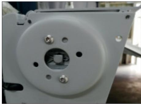
**4.** Använd en skravmejsel och skruva bort skruvarna på huvens låsplatta.
