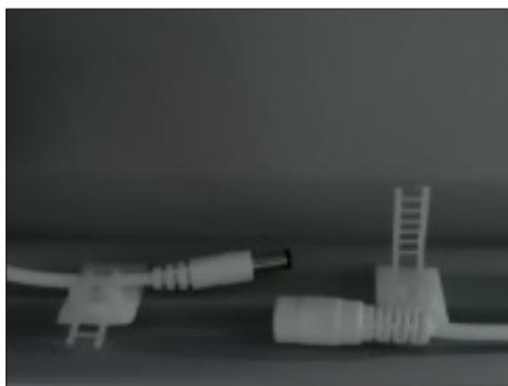
**7.** Ouvrir les fixations de câbles et débrancher les câbles.
