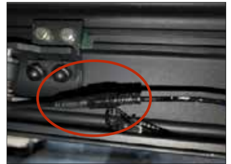
6. Open de draadhouders van de connectoren van de LED-strip binnenin de arm, en maak de connectoren los.
