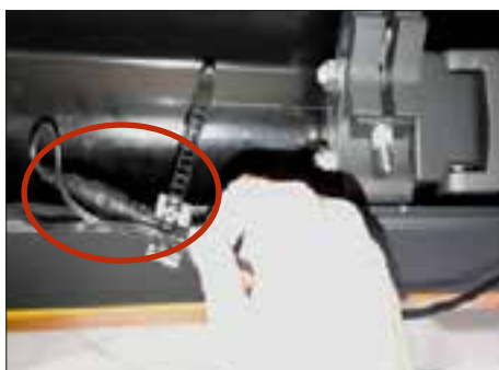
5. Separera kontakterna mellan LED-remsan och motorn.
