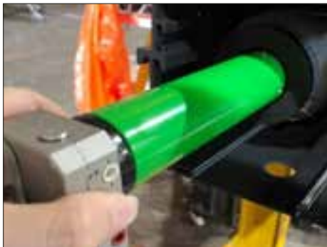
13. Estrarre il motore. Tenere il rullo avvolgitore con entrambe le mani per evitare che l'altro lato del rullo avvolgitore cada dalla staffa.
