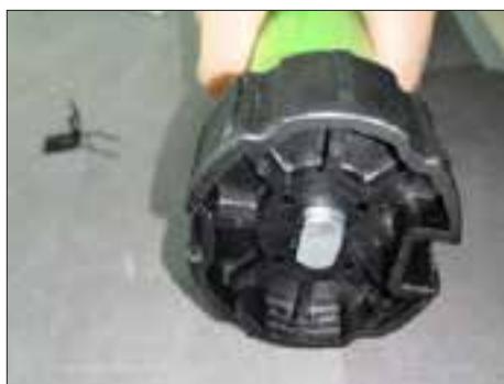
14. Avlägsna låsringen från motorns ovala axel.
