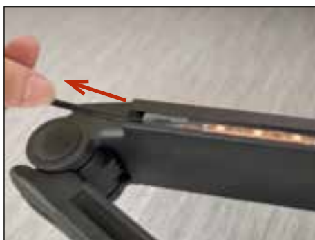
8. Retirer les bandes LED des bras.
