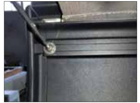
3. Draai de schroeven op de voorbalk los.
