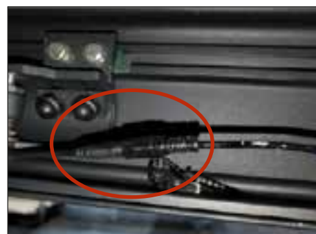
6. Ouvrir les fixations de câbles des connecteurs de la bande LED dans le bras, et séparer les connecteurs.
