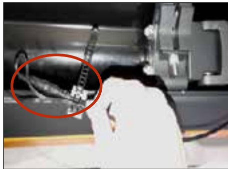
5. Trennen Sie den Steckverbinder zwischen LED und Motor.
