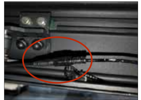
6. Öffnen Sie die Kabelhalter der Steckverbinder im Gelenkarm und trennen Sie die Steckverbinder.
