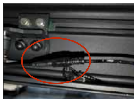
6. Öppna sladdhållarna till LED-remsans kontakter i armen och separera kontakterna.
