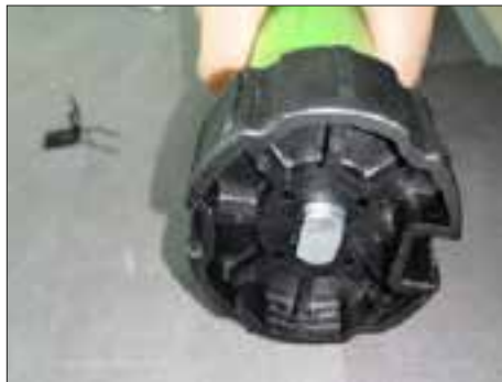
14. Rimuovere l'anello di sicurezza dall'asse ovale del motore.
