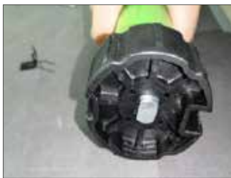
14. Retirer l'anneau de retenue de l'axe ovale du moteur.
