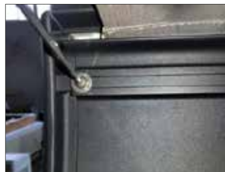
3. Lossa på skruvarna på frambjälken.
