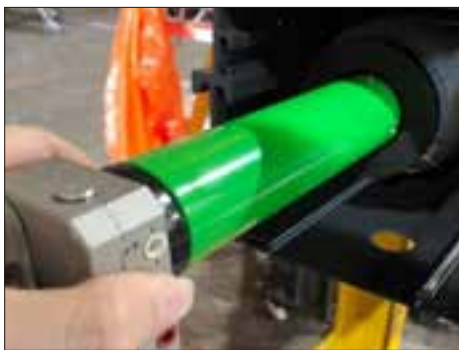
13. Trek de motor eruit. Houd de rolbuis met beide handen vast om te voorkomen dat de andere kant van de rolbuis uit de beugel valt.
