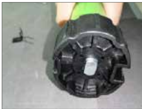
14. Verwijder de borgring van de motoras.
