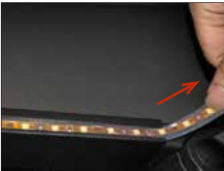
7. Ziehen Sie die LED Streifen aus den Gelenkarmen.
