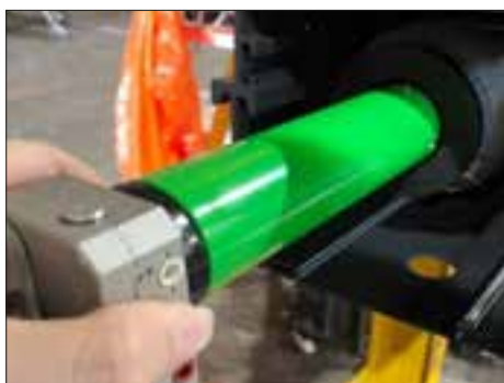
13. Dra ut motorn. Håll valsörret med båda händerna för att undvika att valsörrets andra sida faller ur fästet.
