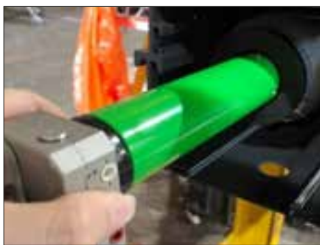
13. Retirer le moteur. Tenir le tube enrouleur des deux mains pour empêcher l'autre côté du tube enrouleur de tomber du support.
