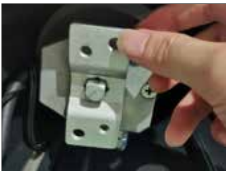
10. Remove the motor holder.
