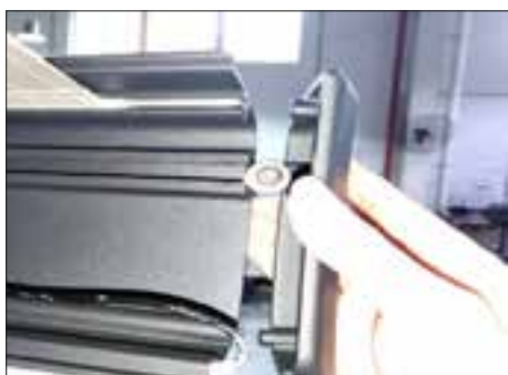
4. Retirer le cache latéral de la barre avant.
