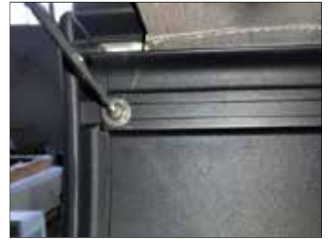
3. Lösen Sie die Schrauben am Ausfallprofil.
