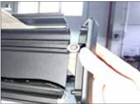
4. Verwijder de zijkap van de voorbalk.
