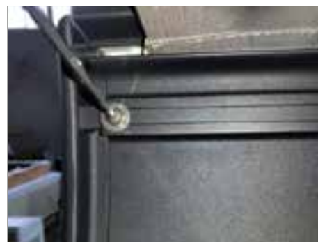
3. Desserrer les vis sur la barre avant.
