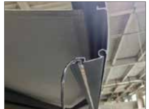
9. Haal de LED-strip uit de LED-houder in de voorbalk.
