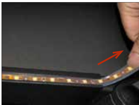
7. Dra ut LED-remsorna från armarna.
