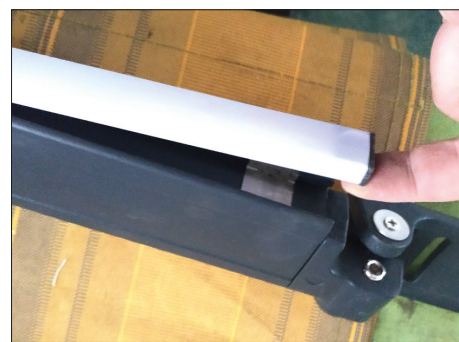
6. Vytiahnite LED žiarivky malých nosníkov na prednej strane nosníkov.
