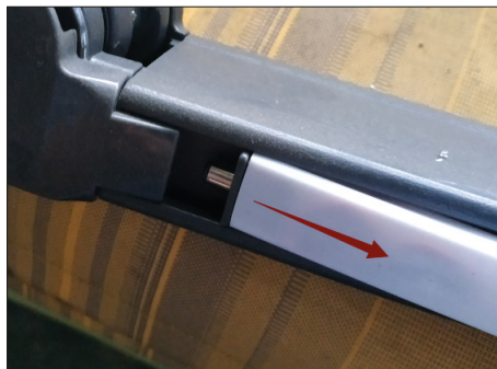
5. Retirer les tubes lumineux LED des poutres.
