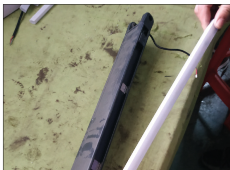
4. Jemně vytáhněte LED světelné trubice z dlouhých nosníků.
