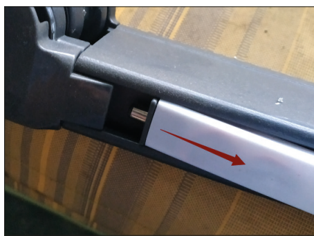
5. Vytiahnite LED žiarivky z nosníkov.
