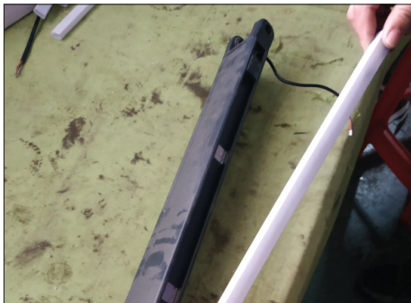
4. Tirer doucement les tubes lumineux LED hors des poutres plus longues.
