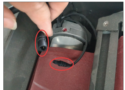
9. Koppla loss LED-kontakten.
