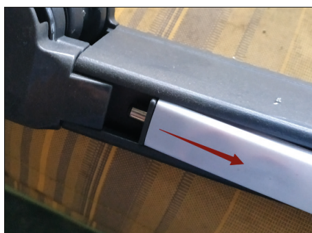
5. Lossa på LED-rören från bjälkarna.
