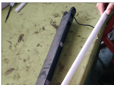
4. Trek de LED-lichtbuizen voorzichtig uit de lange balken.
