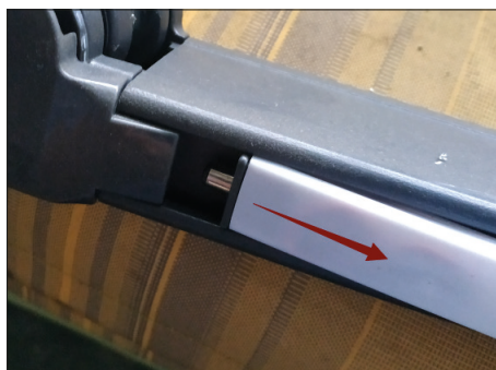
5. Stáhněte LED světelné trubice z nosníků.
