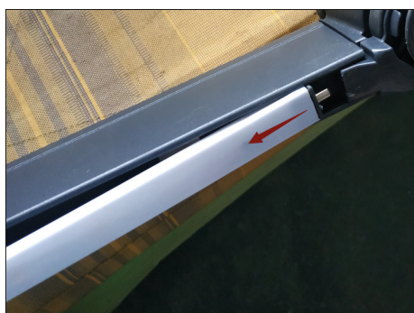
7. Trek de LED-lichtbuizen uit de korte balken.
