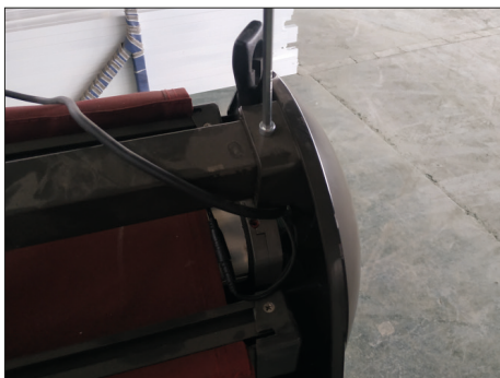
7. Lossa på ändkåporna med en insexnyckel.
