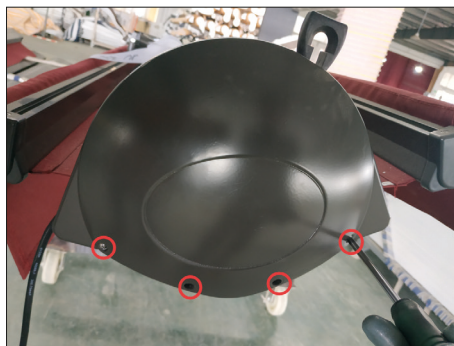
8. Skruva loss ändkåpans stjärnskruvar på motorsidan.
