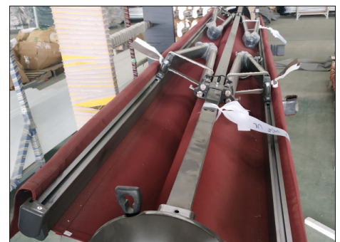
6. Lossa motorns lyfttring och öppna upp lite tyg.
