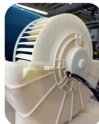
Bei gleichem Luftvolumen liegt die Leistungsaufnahme des DC-Lüfters um 40-50 % unter der eines AC-Lüfters, was das System energieeffizienter macht.
