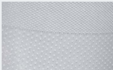
3b. Nahansicht der stark haftenden Klebezone.
