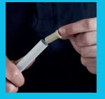
Schritt 3: Hülse einsetzen
