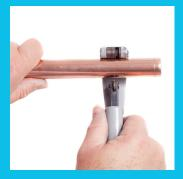
Schritt 1: Schneiden und entgraten
