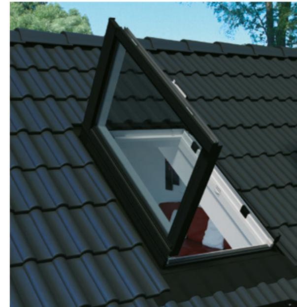
Das Thermoisulations-Ausstiegfenster verfügt über eine Drehkonstruktion, sodass sich der Flügel wie eine Tür zur Seite öffnen lässt. Ein ungewolltes Schließen des Fensters wird durch eine Gasdruckfeder verhindert. Sie ist im oberen Bereich des Flügels angebracht und erleichtert auch das Öffnen des Fensters.
