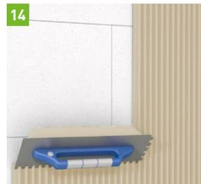
FIX X710 mit 12 mm-Zahntraufel 5 mm dick auftragen.
