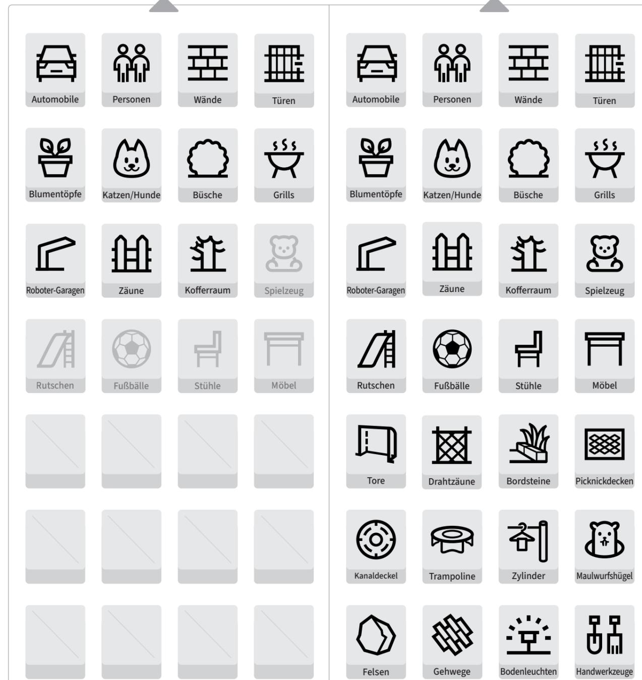
Bei den grauen Objekten können Ultraschallsensoren Probleme haben, sie zu erkennen. Dies hängt von der Größe dieser Objekte und dem Winkel oder der Richtung ab, in der sie erkannt werden.
