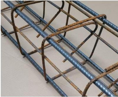
Konfektionierter Bewehrungskorb, R188A, in den Ecken gebunden, mit 4 Baustahlstäben, Durchmesser 10 mm, für die tragende Längsbewehrung, z.B. für Stützen, Stürze und Balken aus Stahlbeton.
