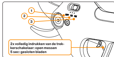
Afbeelding 4: Verschillende posities van de aan/uit-schakelaar en het openen van de bladen.
