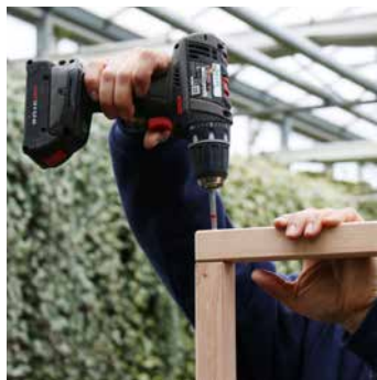
5. Querpfosten oben anschrauben
