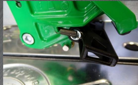
**Die spezielle Brechvorrichtung am Ritzhebel**
