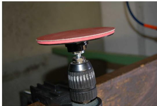
Kaindl Haftschleifteller sind mit sehr hochwertigem Pilzkopf Klettbelag ausgestattet. Dieser sorgt für optimale Haftung der Schleifscheiben auch bei sehr hoher Umdrehungsgeschwindigkeit.
