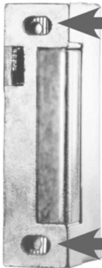
Das Schließblech kann durch die Langlöcher im Türöffner-Gehäuse bis zu 4 mm waagerecht verstellt werden. So kann der Türöffner bei der Montage leicht auf die Schlossfalle ausgerichtet werden.
