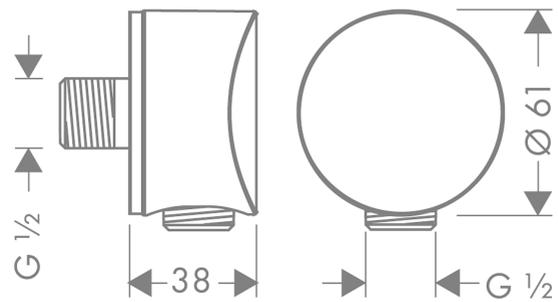
**Fixfit S Schlauchanschluss ohne Rückflussverhinderer mit Metallanschlusswinkel**
