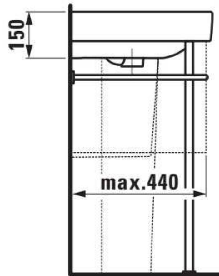
\* = Die effektive Höhe muss entsprechend der Höhe des Sockels fixiert werden.
