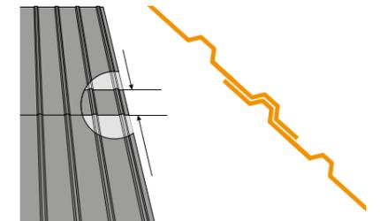
In horizontaler Richtung ist das Trapezblech mit einer Überlappung von mind. 100 mm zu montieren. Es ist erforderlich, links und rechts an der Überlappungsstelle Schrauben zu verwenden. Ebenso müssen die Platten miteinander verschraubt werden.
