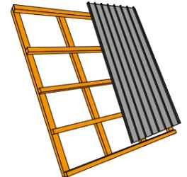
Wird das Trapezblech auf einen unebenen, nicht dichten Altbelag verlegt, so ist eine Holzlattung zum Abführen des Kondenswassers erforderlich. Die Latten müssen evtl. unterfüttert werden, sodass eine ebene Unterkonstruktion entsteht.
