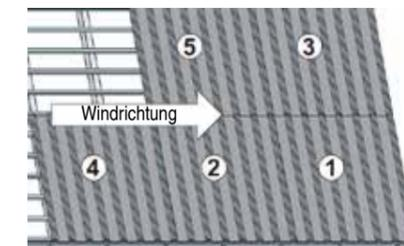
Die weiteren Bleche montieren Sie dann ebenso wie oben dargestellt. Achten Sie darauf, dass Sie immer zunächst die Überlappungen und dann erst die Flächenbefestigung vornehmen. Als letztes schneiden Sie, falls nötig, die Überhänge an First und Ortgang nach.
