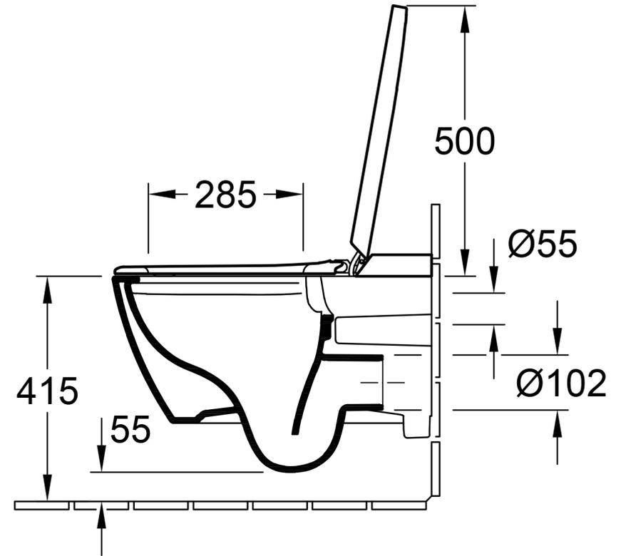
\* Wasser- und Stromanschlussposition in Verbindung mit ViConnect (Art. Nr. 9224 61 00)
