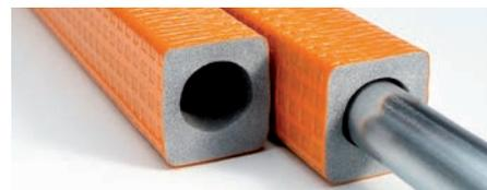
Exzentrisch extrudierte Rohrisolierung aus geschlossenzelligem Polyethylen-Schaum mit NMC Naturefoam® mit einem Anteil von mindestens 50% nachwachsenden Rohstoffen, mit co-extrudierter PE-Folie.
