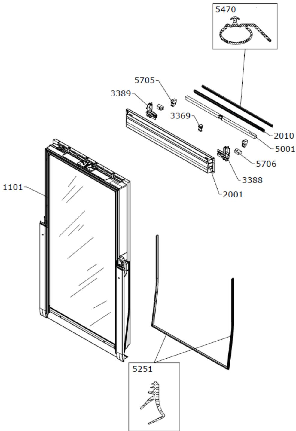
Flügel ohne Scheibe, Beschläge, Dichtungen, Kleinteile, Lüftungsklappe mit Griffleiste
