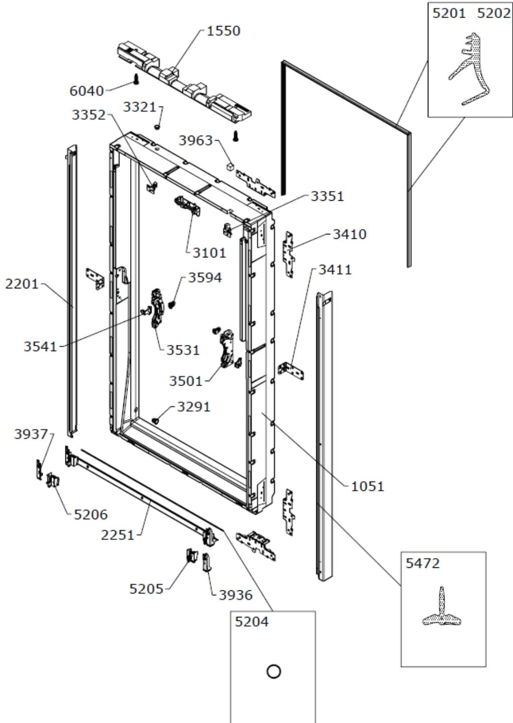
Flügel komplett, Markisenkasten, Dichtungen, Kleinteile
