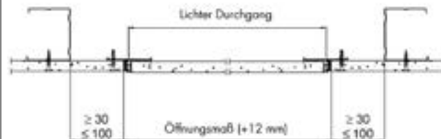
Schemazeichnung AQUAPANEL® Revisionsklappe Feuchtraum
