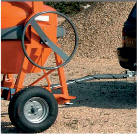
Gefedertes Straßenfahrwerk und Schwenkgetriebe.
