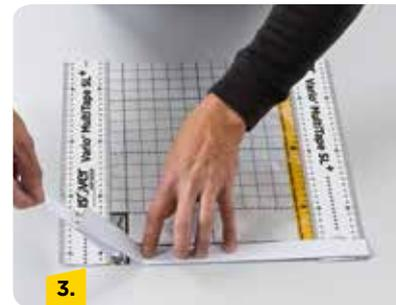
Für die kurzen Seiten der Grundplatte die Klebebandstreifen so bemessen, dass sie die gesamte Folienbreite abdecken. Eine Hälfte des Abdeckstreifens abziehen und auf der Folienkante ankleben. An der gegenüberliegenden Seite genauso verfahren.
