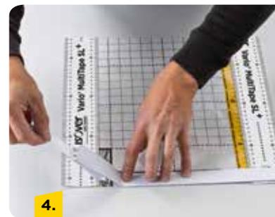
Zuerst die Grundplatte erstellen. Dazu eines der Folienstücke an allen vier Seiten mit den Klebestreifen zu Hälfte (dank Split Liner) umkleben. Stets mit der Beklebung der langen Seite beginnen. Die Klebebänder mit der Andruckrolle anrollen.
