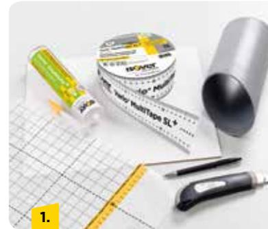
Benötigte Materialien: Rohrreststück mit entsprechendem Durchmesser (einseitig analog der Dachneigung angeschnitten), zwei Folienstücke, Schablone (Breite: Rohrumfang plus 2 cm, Länge: Rohrumfang minus 4 cm), Vario® MultiTape SL+, Vario® DoubleFit+, Cutter, Kugelschreiber.
