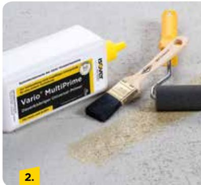
Primer mittels Schaumwalze oder Pinsel gleichmäßig auftragen. Bei stark saugenden Untergründen Vorgang wiederholen. Die Oberfläche ist dauerklebrig und sollte bis zum Anschluss der Klimamembran vor Staub geschützt werden. Vor der Anschlussverklebung muss der Primer vollständig eingezogen sein.
