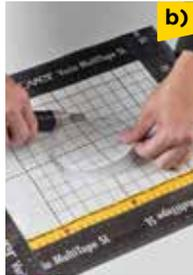
Das Rohrstück mit der abgeschrägten Seite mittig auf die Folie setzen und Umriss anzeichnen (a). Die Rundung ca. 2 mm innerhalb der angezeichneten Umrisslinie mit dem Cutter ausschneiden (b).
