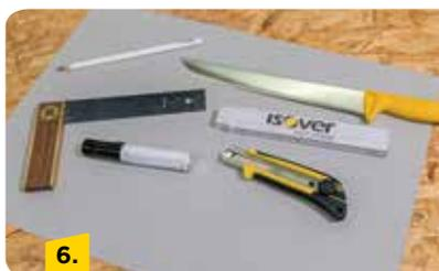
Für die Zuschnitte der jeweiligen Dämmstoffkeile helfen Schablonen. Benötigte Materialien sind: Karton, Bleistift, Winkel, Metermaß, Cutter, dicker Filzstift, Dämmstoffmesser.
