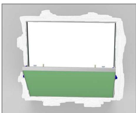
Klappe einhängen, sichern und verschließen.
