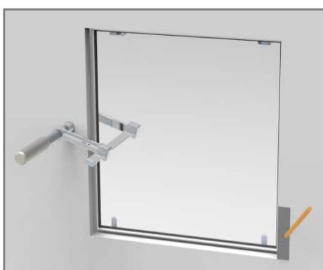
Rahmen ausrichten (Rechtwinkligkeit prüfen), festspannen und Bohrungen mit
