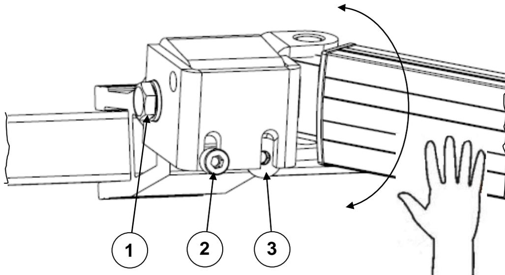
Nach der Neigungseinstellung muss in den meisten Fällen eine Nachjustierung der Ausrichtung der Fallstange (Ausfallprofil) zum Dachprofil der Kassette erfolgen, damit das richtige Schließen der Markise gewährleistet ist. Hierzu wie folgt vorgehen :
