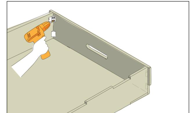
Die Befestigung der Frontseite erfolgt von innen mit 4 Universal-Eckverbindern. Diese jeweils mit 4 Senkkopfschrauben 3x16 mm an den Seitenwänden und der Frontseite verschrauben.
