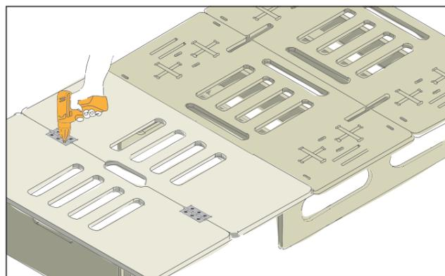
Richte die Platten so aus, dass die Grifföffnung zwischen beiden Platten ist. Verbinde sie mit zwei Scharnieren und Schrauben von 3x16 mm.
