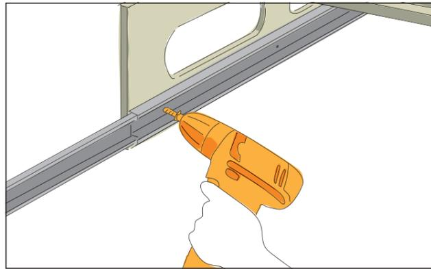
Verschraube die Schubladenschienen so, dass diese im eingeschobenen Zustand vorne bündig sind. Es werden die 4x16 mm Schrauben benötigt. Die Schraubenlöcher müssen nicht vorgebohrt werden.
