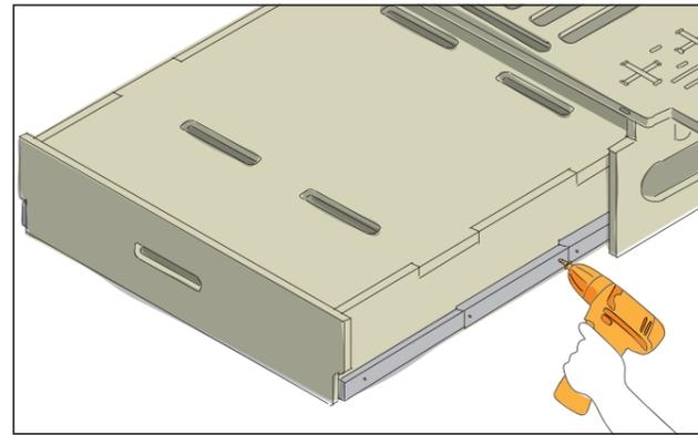
Zum Verschrauben der Schublade mit den beiden Schienen sollte man sie mit 2 mm dicke Unterlegkeile unterbauen, damit sie beim Rein- und Rauschieben frei gleiten kann ohne zu schleifen. Die Schublade vor dem Anschrauben so ausrichten, dass die Frontseite (D) auf allen Seiten leicht Spiel hat. Dann kann die Schublade mit den Schubladenschienen verschraubt werden. Verwende dazu Senkkopfschrauben 4x16 mm.
