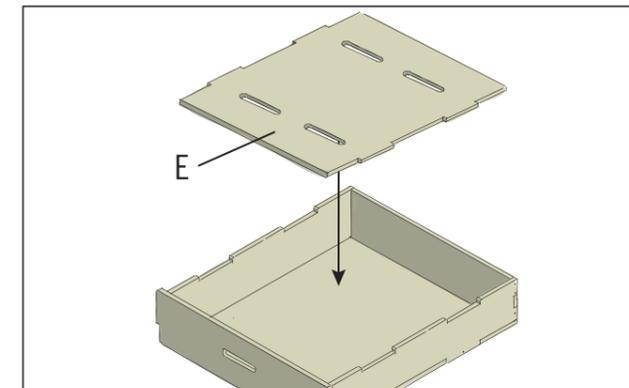
Die Abdeckung (E) wird nur lose aufgelegt. Sie kann zum Befüllen der Schublade leicht abgenommen werden.
