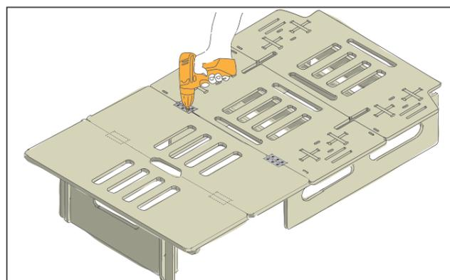
Die beiden Platten umdrehen und an den zuvor aufgesteckten Abdeckplatten mit zwei Scharnieren und Schrauben von 3x16 mm anschrauben.
