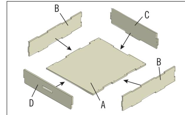
Die Seitenwände (B) und die Rückwand (C) werden an den Aussparungen der Grundplatte (A) eingesetzt. Die Verschraubung erfolgt von unten durch die Grundplatte mit 3,5x35 mm Schrauben. Zusätzlich werden diese seitlich am unteren Rand an den vorhandenen Schraubenlöchern verschraubt. Die Frontseite (D) wird an den Seitenwänden aufgesteckt.
