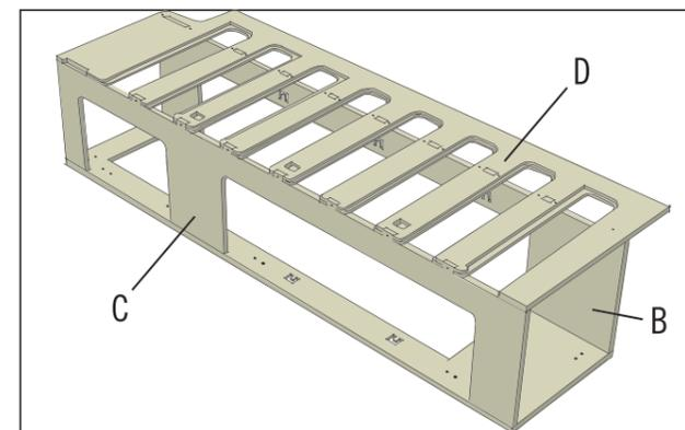
Von oben wird das Rostelement (D) aufgesteckt. Die Zapfen an der oberen Kante der Seitenteile (B) und (C) passen genau in die Ausfräsungen des Rostelementes. Neben den Verzapfungen befinden sich Bohrlöcher. Verschraube die Elemente hier mit 3x25 mm Holzschrauben.
