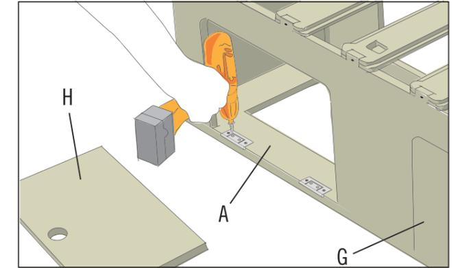
Schraube zunächst für die beiden Frontklappen (G) und (H) jeweils zwei Lamellentürscharniere an jede Klappenöffnung. Die Scharnierachsen dienen dabei wieder als Anschlag. Sie müssen direkt am Grundelement (A) anliegen. Verschraube die jeweils äusseren Scharnierteile mit dem Grundelement (A). Verwende hierfür Holzschrauben Senkkopf 3x16 mm. Um dann die Frontklappen (G) und (H) mit den Scharnieren zu verschrauben, gehst Du genauso vor, wie bei den Stirnseitenklappen.
