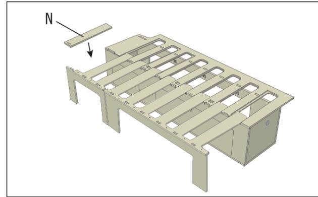
In ausgefahrenem Zustand des Rostes wird das Arretierstück (N) eingesetzt, um die Konstruktion zu stabilisieren. Dieses kann optional zur Aufbewahrung mit Klettband am Korpus befestigt werden, um es bei Bedarf gleich zur Hand zu haben.
