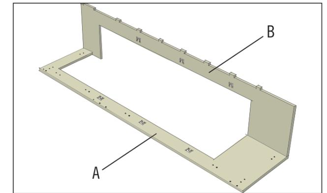
Das Seitenteil (B) sitzt auf der hinteren Kante des Grundelementes (A). In den schmaleren der beiden senkrechten Schenkel ist unten eine Stufe eingearbeitet, die genau in das Grundelement greift.
