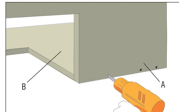
Im Grundelement (A) befinden sich Bohrlöcher, durch die es mit dem Seitenteil (B) verschraubt wird. Kippe die Konstruktion zum Verschrauben nach hinten. Verwende hier 3x25 mm Holzschrauben.
