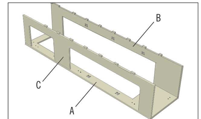
Verschraube das Seitenteil (C) parallel zu (B) auf dem Grundelement (A) mit 3x25 mm Holzschrauben. Kippe dafür die Konstruktion nach vorne und stütze das Seitenteil (B) ab, während (C) verschraubt wird.
