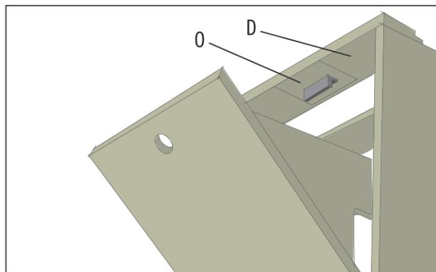
Für die genaue Platzierung der Arretierung des Möbelschlösses verwendest du die Schablone (O). Lege diese mittig an der vorderen Kante der Klappenöffnung an und füge die Arretierung ein. Diese wird mit zwei Holzschrauben Senkkopf 3x16 mm von unten am Rostelement (D) verschraubt.
