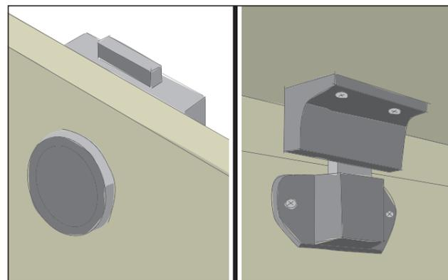
Verschraube die Möbelschlösser Push Lock Mini an den dafür vorgesehenen Ausfräsungen in den beiden seitlichen Klappen mit je zwei Holzschrauben Senkkopf 3x16 mm. Von aussen lassen sich die Möbelschlösser per Knopfdruck öffnen.
