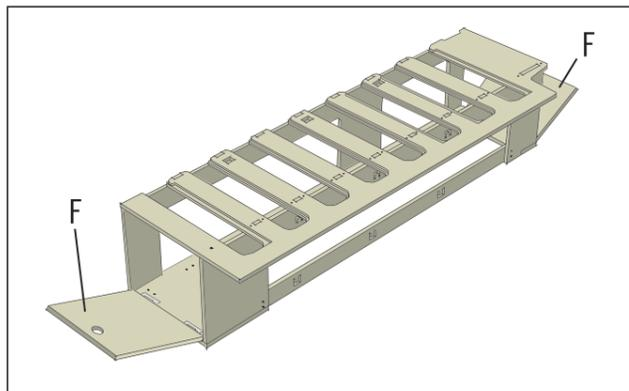
sich, ein Brettchen in der Stärke der Scharnierachsen dazwischen zu klemmen. Achte beim Anschrauben der Klappe darauf, dass die Ausfräsung für das Möbelschloss unten sitzen muss. Prüfe, ob sich die beiden Stirnseitenklappen (F) öffnen und schliessen lassen, ohne zu haken. Sonst musst Du die Verschraubung der Scharniere noch nachjustieren.
