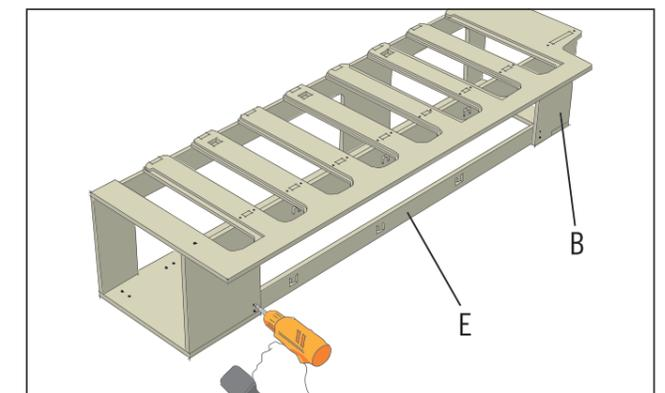
Füge den Quersteg (E) zwischen die beiden senkrechten Schenkel des Seitenteiles (B) von innen ein und verschraube ihn mit 3x25 mm Holzschrauben von aussen.
