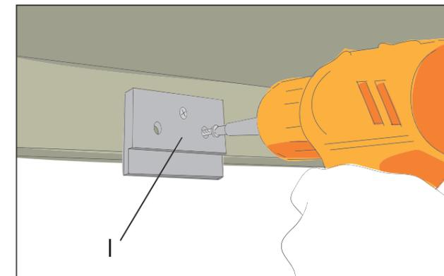
Die Anschläge (I) für die beiden Möbelschlösser der Frontklappen werden im Stauraum von innen jeweils in der Mitte der Klappenöffnung angeschraubt. Verwende Holzschrauben Senkkopf 3x16 mm.
