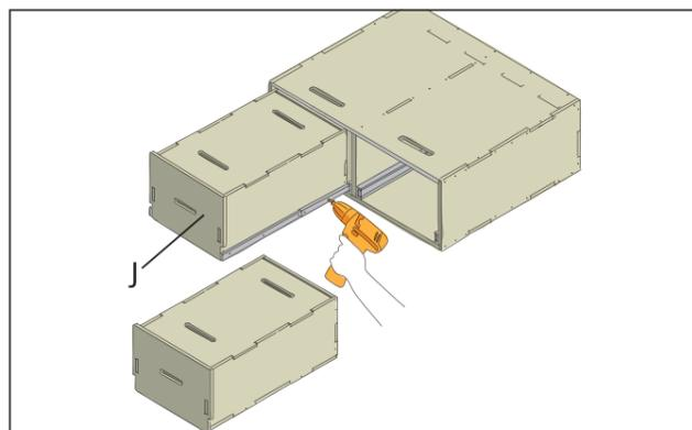
Die Montage der Schublade sollte auf einem ebenen und stabilen Untergrund erfolgen. Zum Ausrichten der Schublade kann man sehr gut Unterlegkeile verwenden. Sie sollte mit 17 mm unterbaut werden, damit sie beim Rein- und Rauschieben frei gleiten kann ohne zu schleifen.
