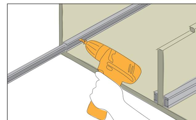
Verschraube die Schubladenschienen so, dass diese im eingeschobenen Zustand vorne bündig sind. Es werden die 4x16 mm Schrauben benötigt. Die Schraubenlöcher müssen nicht vorgebohrt werden.
