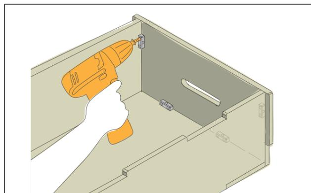
Die Befestigung der Frontseite erfolgt von innen mit 4 Universal-Eckverbindern. Diese jeweils mit 4 Senkkopfschrauben 3x16 mm an den Seitenwänden und der Frontseite verschrauben.
