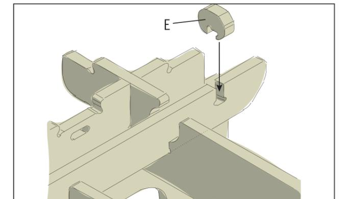
Am Ende der beiden Winkelstreben wird jeweils ein Stopper (E) eingesteckt. Dieser muss so sitzen, dass die Winkelstreben zusammen
