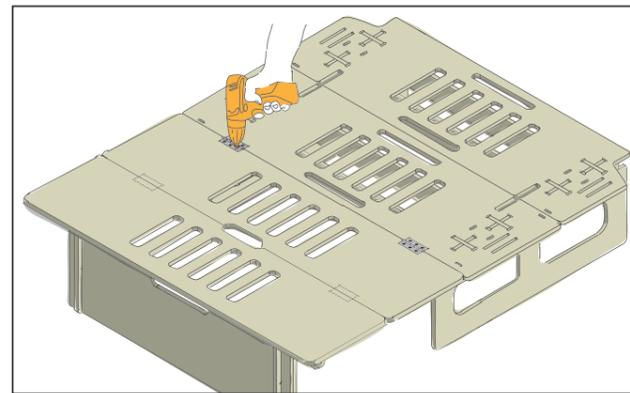
Die beiden Platten umdrehen und an den zuvor aufgesteckten Abdeckplatten mit zwei Scharnieren und Schrauben von 3x16 mm anschrauben.
