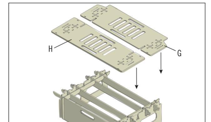
Schiebe die Frontplatte wieder zurück. Jetzt die Abdeckplatte (G) am hinteren Ende so auf die unteren Bauteile aufstecken, dass die ausgesparten Ecken nach aussen angeordnet sind. Die Abdeckplatte (H) bündig daran ansetzen und ebenfalls aufstecken.
