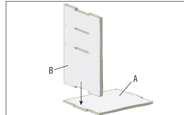
Die Bodenplatte (A) auf einer geraden Unterlage ablegen und die erste Seitenwand (B) am Rand der Bodenplatte in den Zapfen einstecken. Die beiden länglichen Aussparungen in der Seitenwand sind dabei oben.
