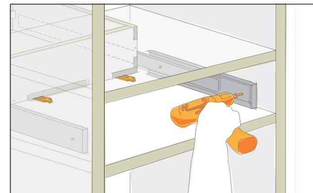
Setze die Schublade in die Schranköffnung ein und unterlege sie mit 2 mm dicken Keilen. Verschraube die Schubladenschienen am hinteren, dicken Teil an den Seitenwänden der Schranköffnung. Verwende Senkkopfschrauben 4x16 mm. Achte darauf, dass die Schienen parallel zur Schranköffnung montiert werden und sich die Schublade leichtgängig verschieben lässt.
