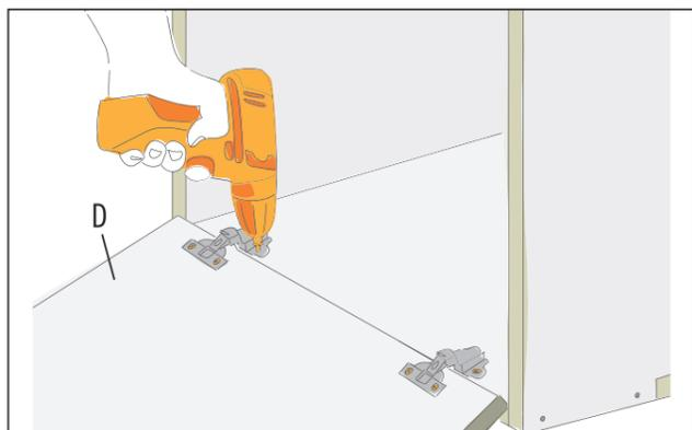
Befestige die Schranktüren (D) und (E) mit den Topfscharnieren an den zuvor gebohrten Befestigungslöchern des Schrankkorpus. Verwende Senkkopfschrauben 3x16 mm.
