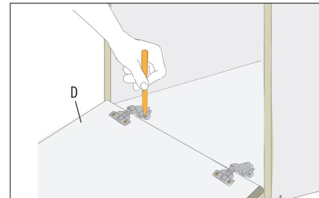
Bereite jetzt die Befestigungslöcher für die Türen am Schrankkorpus vor. Montiere dazu die Topfscharniere an den Türen (D) und (E). Platziere die Türen jeweils an den Montagestellen und markiere die Schraubenpositionen durch die Montageplatten der Scharniere.
