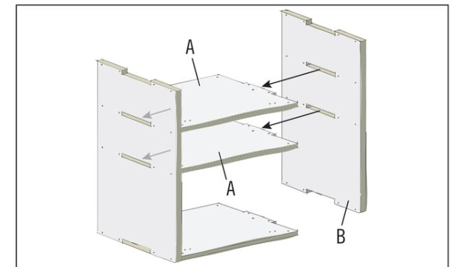
Stecke die beiden Schrankböden (A) in die Aussparungen der Seitenwand. Dann können die beiden Böden durch die Seitenwand mit Senkkopfschrauben 3,5x35 mm verschraubt werden.
