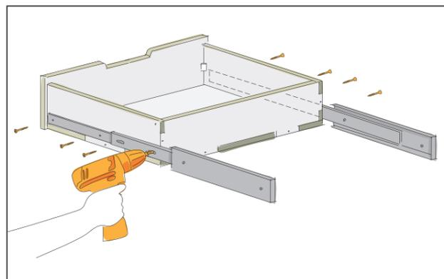
An der Schublade werden zwei Schubladenschienen angebracht. Ziehe die Schienen komplett auseinander und verschraube sie mit Senkkopfschrauben 4x16 mm durch den mittleren Teil des Auszuges direkt über der Bodenplatte der Schublade. Dann am vorderen Auszug ebenfalls an der Schublade verschrauben. Achte darauf, dass die Schienen parallel zur Schublade montiert werden.
