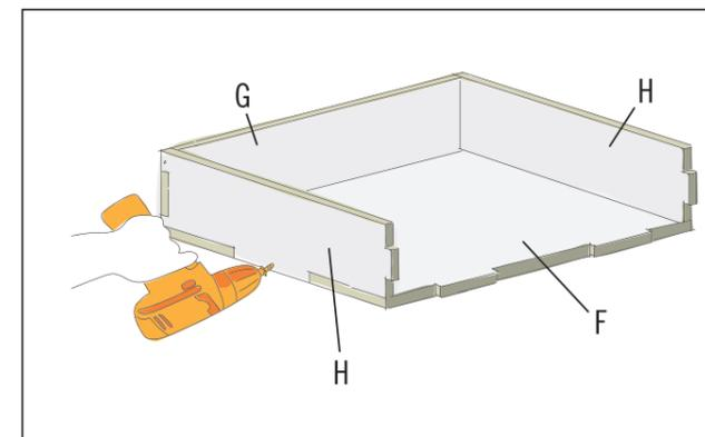
Verschraube die beiden Seitenwände (H) und die Rückwand (G) an der Grundplatte (F). Die Verschraubungen erfolgen von der Seite in die Grundplatte und dann durch die Grundplatte in die Wände. Es werden Senkkopfschrauben 3,5x35 mm verwendet.
