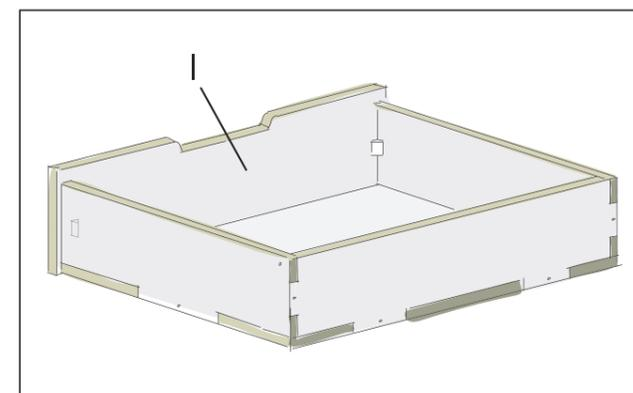
sen nicht vorgebohrt werden. Danach kann die Frontplatte (I) an den Zapfen der Seitenwände und Grundplatte aufgesteckt und an den Eckverbinder angeschraubt werden.
