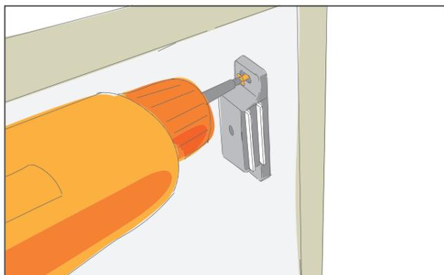
Als Anschlag für die Türen werden Magnetschnäpper an den markierten Positionen montiert. Die beiliegenden Metallplättchen werden an den Türen so angebracht, dass diese an den Magneten festgehalten
