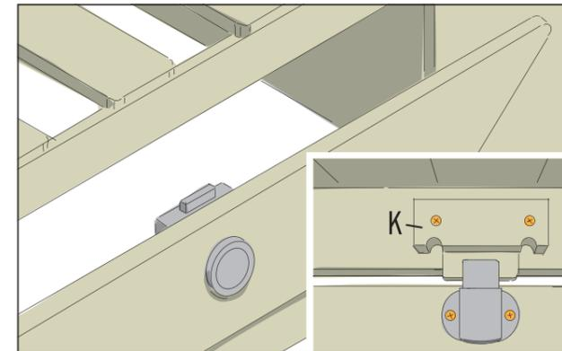
Jetzt wird das Push Lock Möbelschloss montiert. Dazu den bei der Campingbox mitgelieferten Anschlag (K) von innen passend zum Push Lock Möbelschloss anbringen. Es werden 4 Senkkopfschrauben 3x16 mm benötigt.
