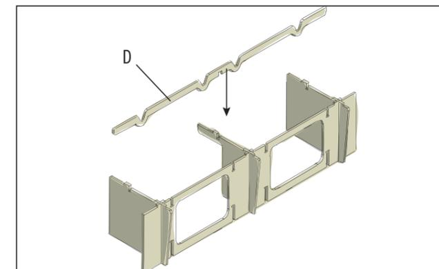
Verbinde die drei Wandelemente so mit der Strebe (D), dass die Strebe auf beiden Seiten übersteht. An der Oberkante muss die Strebe bündig mit den Wandelementen abschliessen.
