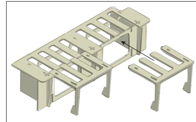
Verbinde die beiden Ausziehelemente mit dem Gehäuse. Die Finger der Abdeckplatten passen genau zusammen. Die Ausziehelemente kannst Du dann zum Stopper nach vorne ziehen.
