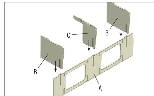
Verbinde die beiden Wandelemente (B) aussen und das Wandelement (C) in der Mitte mit der Frontseite (A). Stecke die Elemente dazu in die vorgesehenen Aussparungen.
