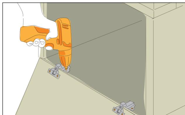
Die Befestigung der beiden Türen erfolgt mit jeweils zwei Topfscharnieren an den vorgesehenen Öffnungen. Die Scharniere werden mit 3x16 mm Schrauben verschraubt.
