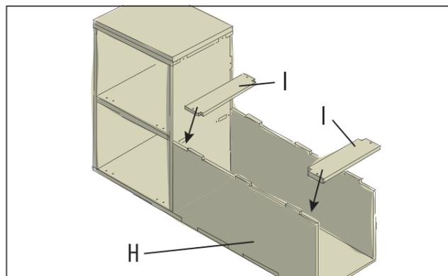
Die Frontplatte (H) mit der Bodenplatte zusammen stecken. Die beiden Verbindungsbretter (I) links und rechts auf den Korpus aufstecken und von oben an der Rückseite und Frontplatte verschrauben. Zum Verschrauben der Frontplatte am Boden den gesamten Korpus zur linken Seite kippen.
