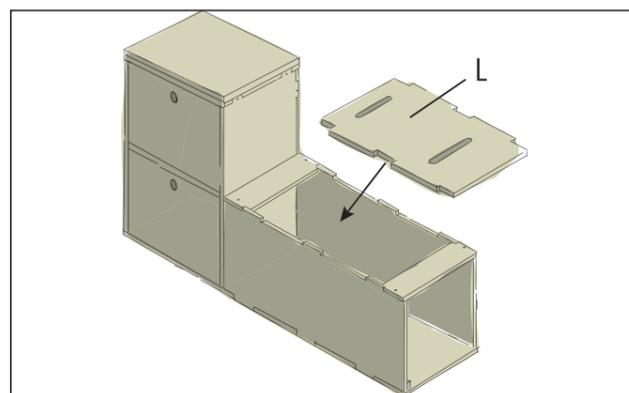
Die Abdeckung (L) kann probeweise aufgelegt werden. Sie bleibt auch später lose, damit sie zum Beladen der Schublade abgenommen werden kann.
