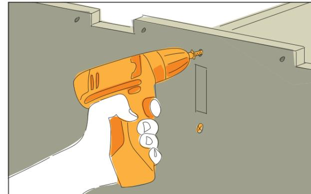
Alle Bauteile des Schrankkorpus werden an den vorhandenen Bohrlöchern mit 3,5x35 mm Schrauben verschraubt. Dazu den Korpus zur Seite kippen und die beiden Wandelemente durch die Bodenplatte verschrauben. Den Zwischenboden durch die beiden Wandelemente verschrauben.
