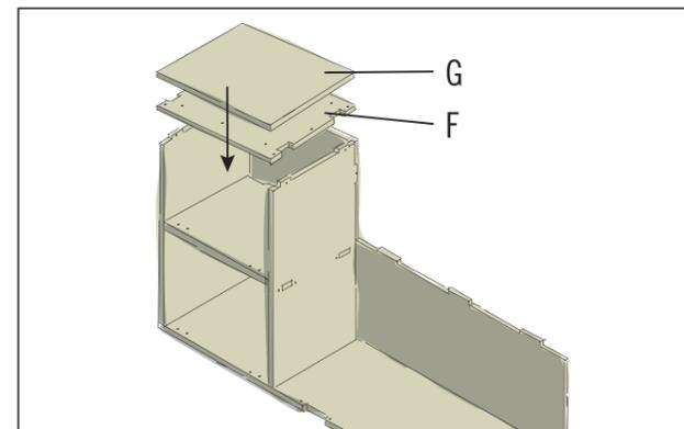
Die Abdeckplatte (F) aufstecken und mit den Wandelemente und der Rückwand verschrauben. An der Rückseite hat die Abdeckplatte 6, vorne 3 Bohrlöcher. Auf die Abdeckplatte die Arbeitsplatte (G) auflegen. Diese hat keine Bohrlöcher.
