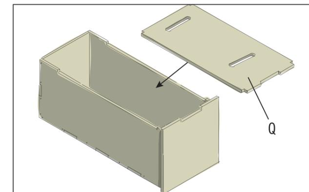
Die Abdeckung (Q) wird lose aufgelegt - also nicht verschraubt. Sie kann zum Beladen der Schublade an den Griffschlitzen leicht abgenommen werden. Jetzt müssen noch die Schubladenschienen montiert werden.
