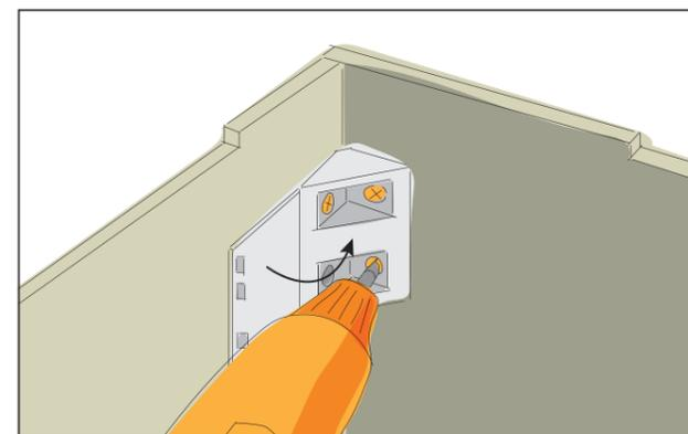
Die Schubladenfront an den beiden Wandelementen von innen mit jeweils zwei Eckverbindern und Schrauben 3x16 mm verschrauben.
