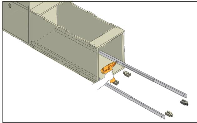
Die beiden Schubladenschienен für die Schublade werden unten im Korpus an den Wänden mit 4x16 mm Schrauben verschraubt. Die Montage der Schublade sollte auf einem ebenen und stabilen Untergrund erfolgen. Zum Ausrichten der Schublade kann man sehr gut Unterlegkeile verwenden. Sie sollte mit 17 mm unterbaut werden, damit sie beim Rein- und Rausschieben frei gleiten kann ohne zu schleifen.
