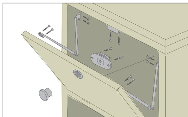
Das Möbelschloss mit Senkkopfschrauben 3x16 mm wie gezeigt an der jeweiligen Tür montieren. Seitlich erhalten die Türen jeweils zwei Klappenhalter. Diese werden mit den mitgelieferten Schrauben befestigt.
