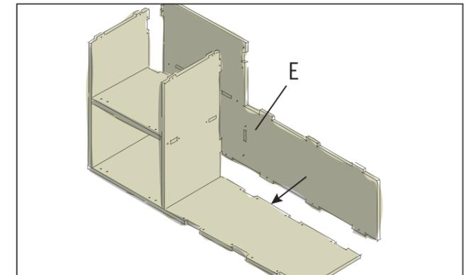
Den Korpus wieder aufstellen. Die Rückwand (E) von hinten ansetzen. Die Zapfen und Aussparungen müssen ineinander greifen. Die Rückwand an den vorgesehenen Bohrlöchern verschrauben.
