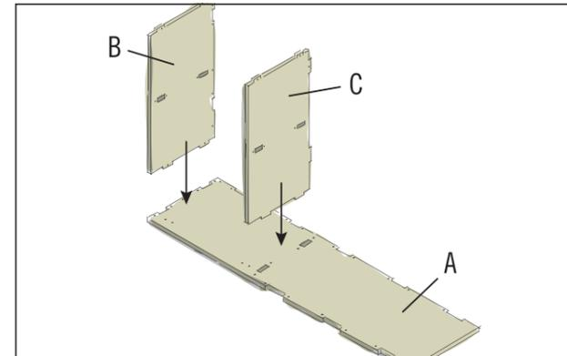
Die nachfolgenden Montagearbeiten am besten zu zweit ausführen. Die Bodenplatte (A) auf einer geraden Unterlage ablegen. In die Aussparungen der Platte die beiden Wandelemente einstecken. Element B kommt nach links. Die Aussparungen sind hinten. Element C kommt nach rechts. Die Zapfen sind hinten.
