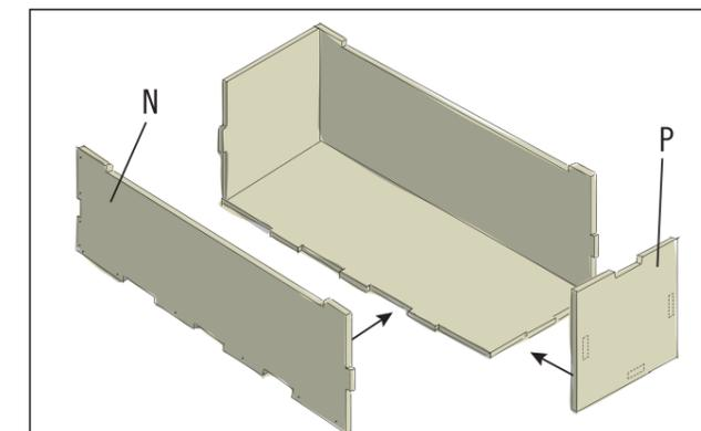
Das Wandelement (N) ebenfalls anfügen und verschrauben. Die Schubladenfront (P) wird von vorne aufgesteckt
