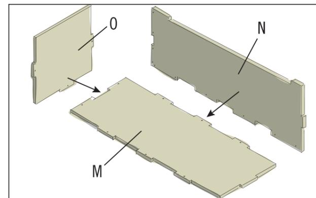
Die Bodenplatte (M) und die Wandelemente (N und O) an den vorgesehenen Aussparungen verbinden und verschrauben. Die Verschraubung erfolgt seitlich und von unten durch die Bodenplatte.
