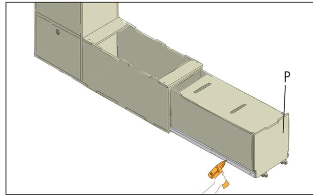
Die Schublade vor dem Befestigen an den beiden Schienen so ausrichten, dass die Frontblende (P) auf allen Seiten leicht Spiel hat. Dann die Schublade mit 4x16 mm Schrauben mit den Schubladenschiene verschrauben. Beim Ausrichten weiterhin darauf achten, dass die Schienen parallel zur Schublade verlaufen.
