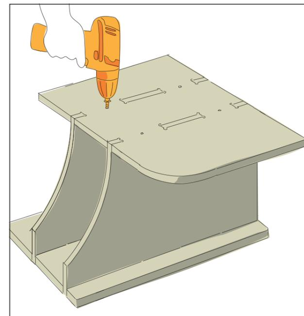
Drehe an den vorhandenen Schraubenlöchern jeweils eine Senkkopfschraube 3,5x35 mm ein. Die Schrauben soweit eindrehen, dass der Schraubenkopf bündig mit der Holzoberfläche abschliesst.
