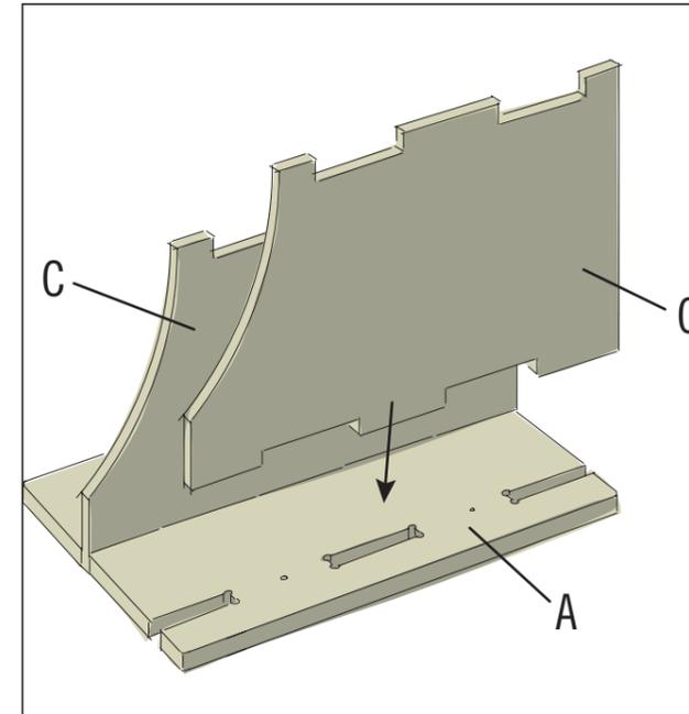
Lege die kurze Seitenwand (A) auf einer flachen Unterlage ab. Die beiden Regalböden dann mit den Zapfen in die Aussparungen einstecken.
