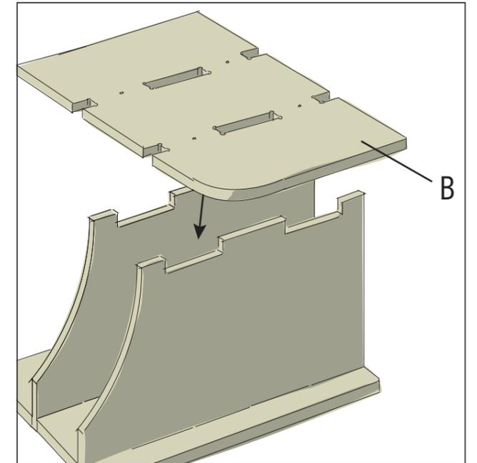
Die Seitenwand (B) mit den Aussparungen auf die Regalböden aufstecken. Hinweis: Beim spiegelverkehrten Zusammenbau muss die Seitenwand ebenfalls gedreht werden.
