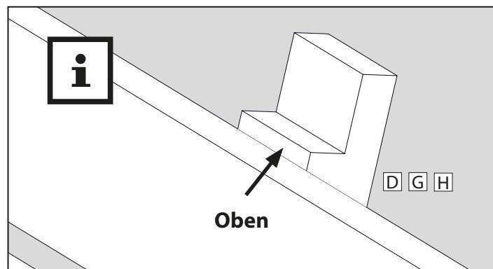
Alle Seitenteile **D**, **G** und **H** verfügen über einen verlängerten Holm. Dieser zeigt bei der weiteren Montage immer nach oben.
