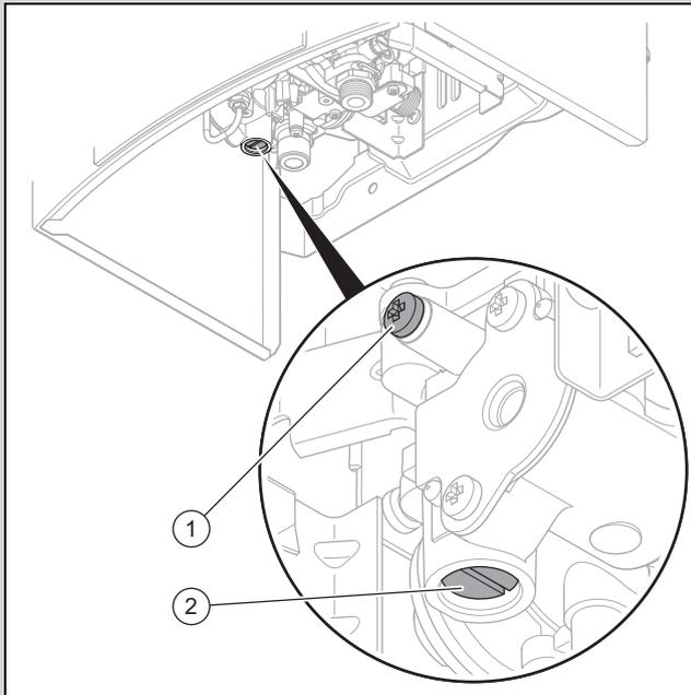
1. Drehen Sie den Temperaturwähler bis zum Anschlag im Uhrzeigersinn, um die Wassermenge zu verringern und die maximale Wassertemperatur einzustellen.
