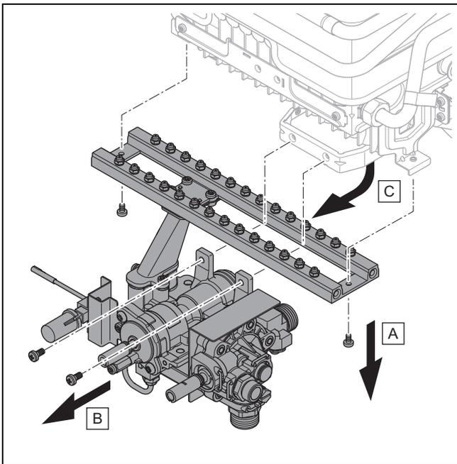
6. Entfernen Sie die zwei Schrauben am Düsenstock.
