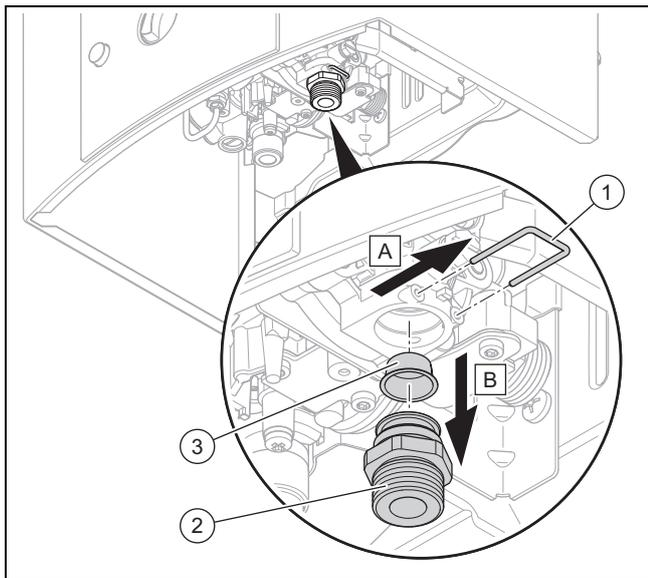
1. Entfernen Sie die Kaltwasseranschlussleitung vom Kaltwasseranschluss (2).
