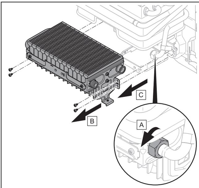
9. Schrauben Sie die Überwurfmutter des Wasseranschlusses des Wärmetauschers am Brenner ab.
