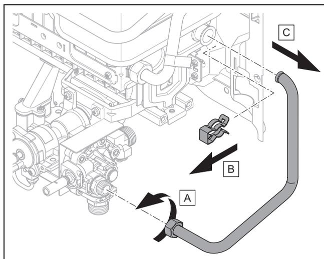
4. Schrauben Sie die Überwurfmutter am Wasserventil ab. Entfernen Sie den Clip am Kaltwasseranschluss des Brenners.
