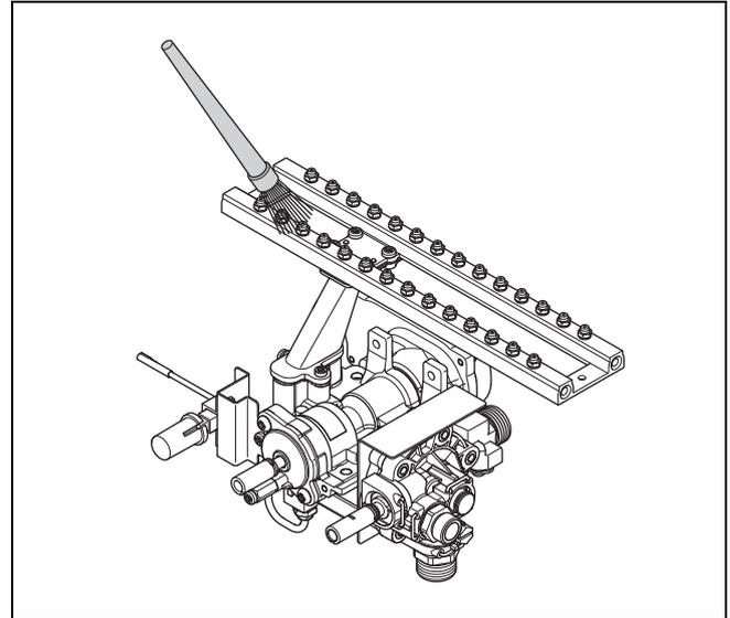
1. Prüfen Sie die Bauteile des Düsenstocks auf Verschmutzungen und Beschädigungen. Demontieren Sie auf keinen Fall die Brennerdüsen!
