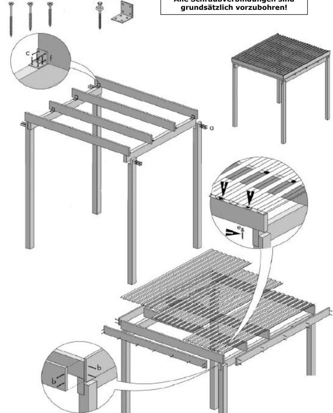
Befestigen Sie die Dachplatten mit den mitgelieferten Dachplattenschrauben im **Wellental**. Senkrechtes Einschrauben gewährleistet eine höchstmögliche Dichtigkeit. Die Schraube ist richtig angezogen, wenn die Scheibendichtung ca. 1 mm unter der Unterlegscheibe heraustritt (siehe Detailzeichnung). Achten Sie darauf, dass jedes überlappende Wellental immer mit einer Spezial-Schraube befestigt wird.
