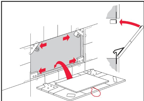
Die Revisionsklappe mit Einhängetechnik und Ausklink-Sicherung ist ein „Spitzenprodukt“ für unsichtbare Revisionsklappen in Fliesenwänden.
