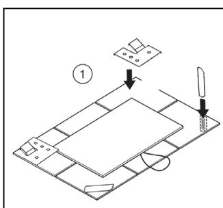
Metallstreifen, Einhängevorrichtung und Schnur aufkleben. Mehrere Fliesen mit geeignetem Material zusammenkleben (Silikon).
