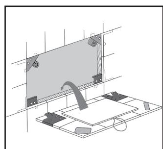
Abdeckung einhängen und schließen. Öffnungskordel in die Fliesenfuge einlegen.
