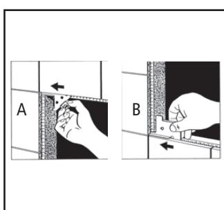
Magnetwinkel (A) und Einhängehalterung (B) bei noch weichem Fliesenkleber in die Fliesenfugen einsetzen.
