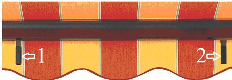
Bei der Gelenkarmmarkise sind am Ausfallprofil 2 Stahlwinkel (Armanschläge, 1 und 2 im Bild) montiert. **Es handelt sich hierbei nicht um eine Transportsicherung. Die Winkel dürfen nicht entfernt werden.**
