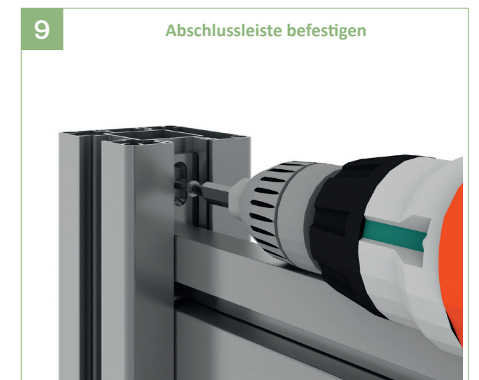
9 | Die Halterungen mit den 3,9 x 25 mm Bohrschrauben (im Lieferumfang enthalten) am Pfosten mittig vom Langloch befestigen.
