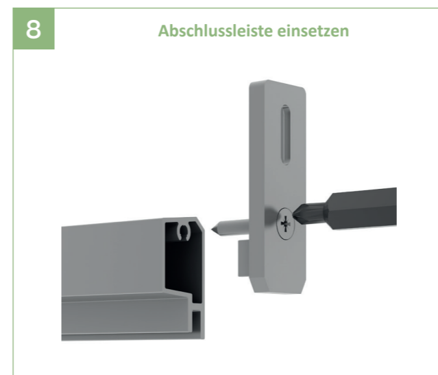
8 | Die Halterungen für die Abschlussleiste mit den 3,9 x 25 mm Blechschrauben (im Lieferumfang enthalten) in die Abschlussleiste verschrauben.
