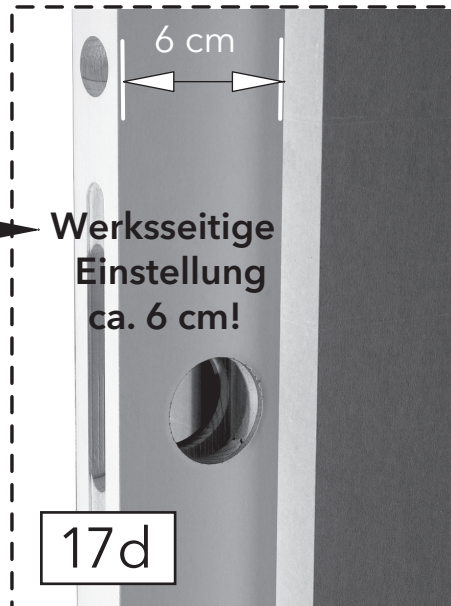
17 d) Wenn Sie die Lauf- schiene nicht ausbauen und die werksseitige Einstellung belassen, steht das Türblatt ca. 6 cm in die Durch- gangsbreite ein.
